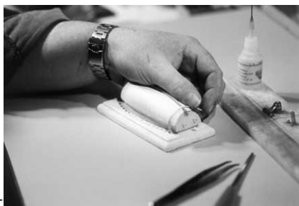
Der erste Spant wird eingesetzt.
