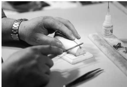
In den Kiel wird eine Kerbe für den ersten Spant gearbeitet.
