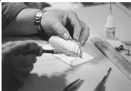
Alle Spanten sind gesetzt, die ersten Planken werden mit der Form- und Biegespitze angebracht.
