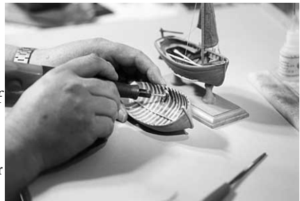
Mit einer kleinen Drahtbürste werden Klebstoffreste entfernt.
