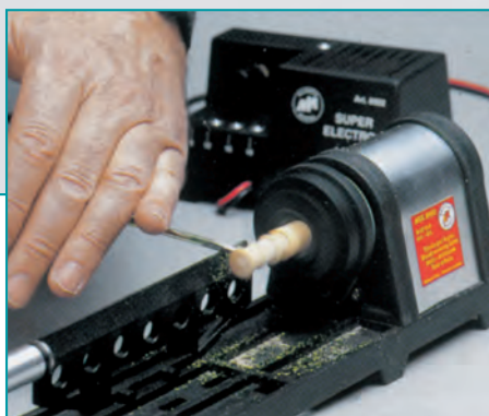
Dreheln einer Außenkontur mit Stechbeitel.
