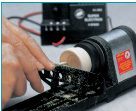
Innenausdrehen mit Stichling und Auflagebock.
