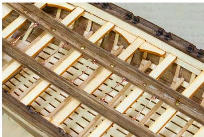
Abschließend werden die Kupferösen mit Kupferdraht (Position 3 / Karte 1) verbunden. Richten Sie dazu den Draht aus, hängen ihn dann auf einer Seite ein und spannen ihn auf die andere Seite.
