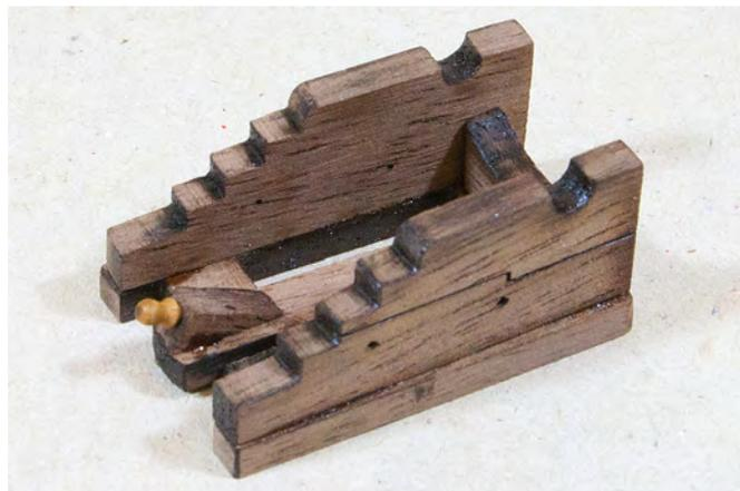
Bohren Sie ein 1,5 mm Loch in den Richtkeil für einen Belegnagel, und kleben ihn dann auf den Längsträger.
