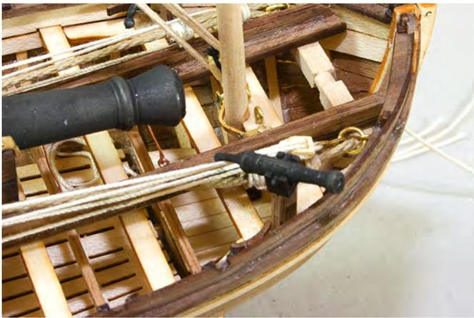
Für Nägel in den Laschen können Sie dann wie gehabt vorbohren, die Nägel kürzen und einkleben. Jetzt noch die beiden Stiftösen S4 und S5 setzen.
