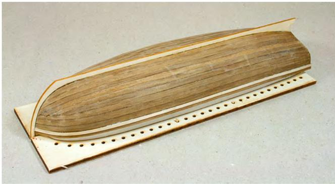
Bohrung in der Bodenplatte (einfach bis zum Rand aufschneiden. Achten Sie auf einen guten und spannungsfreien Sitz des zweiten Kielteils (notfalls etwas nacharbeiten) und kleben es dann auf das erste Kielteil.
