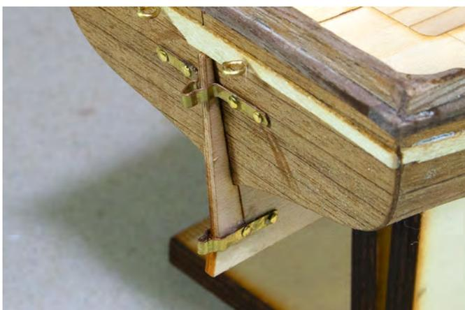
Nehmen Sie zwei Ruderscharniere aus Position 1 / Karte 1 bringen Sie diese am Kiel und Heckspiegel an. Das obere Scharnier müssen Sie dazu (wie auf dem Bild) mit einer Flachzange biegen. Auch hier wieder mit einem 0,8 mm Bohrer bohren und die Messingnägel einkleben, im Kielteil schneiden Sie die überstehenden Nägel ab.
