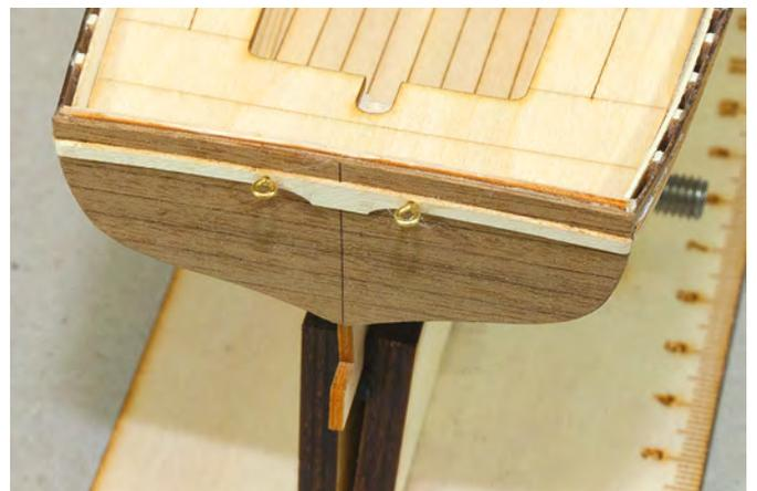
Vor dem Aufbringen des Handlaufes (Karte 3) sollte Sie die Bordwand mit den Spanten und der Ruderbankstützleiste mit einer Schleiffleie überschleifen um eine gute Auflagefläche für den Handlauf zu erhalten.
