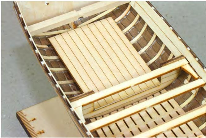
Jetzt wird das Bodenbrett (Position 2 / Karte 1) auf das Schott und die Stütze auf Spant 29 geklebt.
