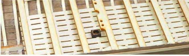
Als nächstes werden die Ruderbänke (Platine Karte 3) auf die Ruderbankstütze geklebt. Mit ein paar Gummibändern kann man den Rumpf leicht auf die endgültige Breite bringen. Achten Sie bitte darauf, dass Sie keine Dellen in den Rumpf drücken, der Rumpf sollte an der breitesten Stelle ca. 74 mm breit sein. Nachdem Sie die Ruderbänke angepasst haben, können Sie sie einkleben.
