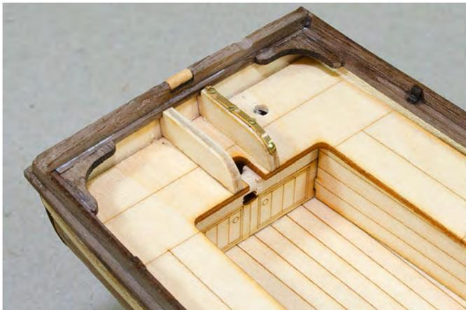
Passen Sie die Abweiser an und kleben sie auf die achterne Sitzbank. Sobald der Kleber getrocknet ist, können Sie die Messingauflagen aufkleben, bohren Sie dann, mit einem 0,8 mm Bohrer, durch die Messingauflage und kleben die Messingnägel 0,7 x 7 mm ein. Kürzen Sie die Nägel, dann müssen Sie nicht so tief bohren.
