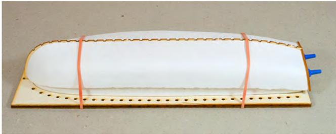
Trennen Sie das ausgelaserte Kielteil (Position 1 / Karte 2) in zwei Teile. Legen Sie den oberen Teil erstmal an die Seite, den unteren Teil mit dem vorderen Ende am Bug beginnend in die Bohrung stecken, auf dem Mittelteil der Form mit Furniernadeln oder kleinen Nägeln mittig befestigen (rechts u. links vom Kielteil), Sie können das Kielteil auch mit Gummibändern fixieren. Verkleben Sie dann das Kielteil mit dem Heckspiegel.
