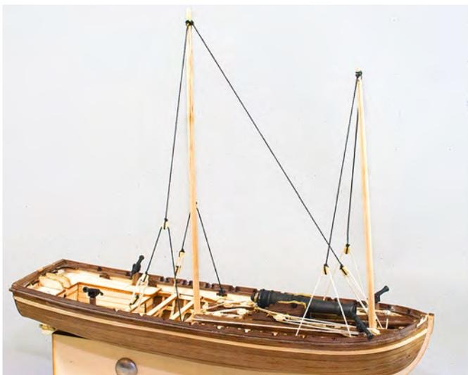
Die Takel für das Seitenstak werden in den Stiftösen S1 und S8 eingehakt und an der Ruderbank R2 festgemacht. Vom Takel läuft ein Tau durch einen 4 mm 1er Block und wird an K4 bzw. K11 belegt. Der 1er Block wird mit einem Tau oberhalb der Mastbohrung befestigt.
