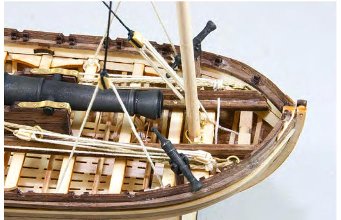
Der vordere Mast wird nur mit zwei einfachen Seitenstaks gehalten. Diese werden mit einem 4mm 1er Block an der Ruderbank R8 sowie den Klampen K6 und K9 belegt.
