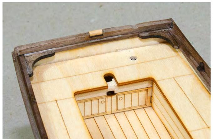
Die Rolle fertigen Sie bitte aus einem kleinen Abschnitt des Ruten Materials (Position 7 / Karte 2).
