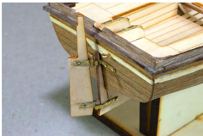
Nun können Sie die beiden Setzbord verstärkungen links und rechts vom Kiel aufkleben. Die Verstärkung mit der Ausbuchtung befindet sich auf der rechten Seite (vom Heck aus gesehen). Mit einer Runden Nadelfeile können Sie dann die Ausbuchtung der Verstärkung auf das Setzbord übertragen.
