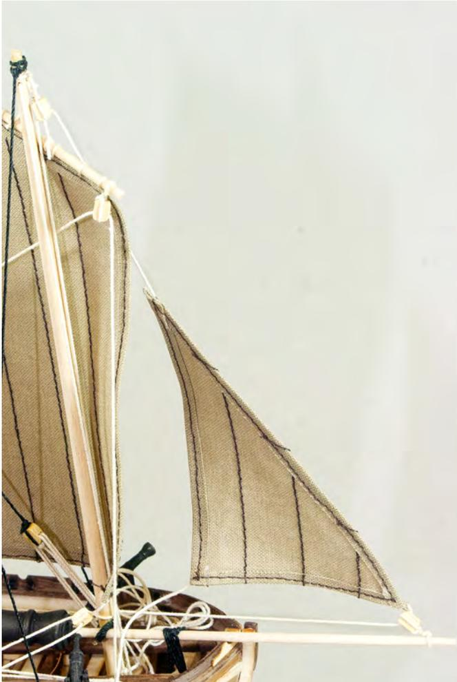
Bleibt nur noch das Bugsprietsegel, an den drei Spitzen wird ein Tau angenäht. Das Obere läuft durch den Block am vorderen Mast (III) und wird an der Stiftöse S4 belegt. Das vordere Tau läuft durch den Block am Bugspriet und wird am Mast belegt. Das letzte Tau wird dann an der Klampe K7 festgemacht.
