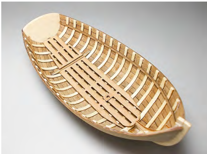
Rumpfschale mit Bodenstütze, Bodenbrett und eingeklebter Ruderbankstützleiste
