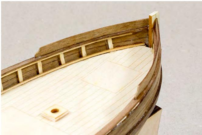
Für die achterne Reling zwei Handlaufstücke vorbeugen (Länge 75 mm) mit Krepband auf den ersten kleben und dann zusammen mit einem 1 mm Bohrer bohren.
