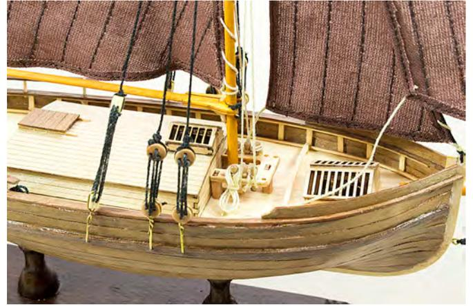
Nähen Sie das Großsegel an die Gaffel V und den Mast II. Die Gaffel wird mit einem Tau durch die Gaffelklaue am Mast gesichert.
