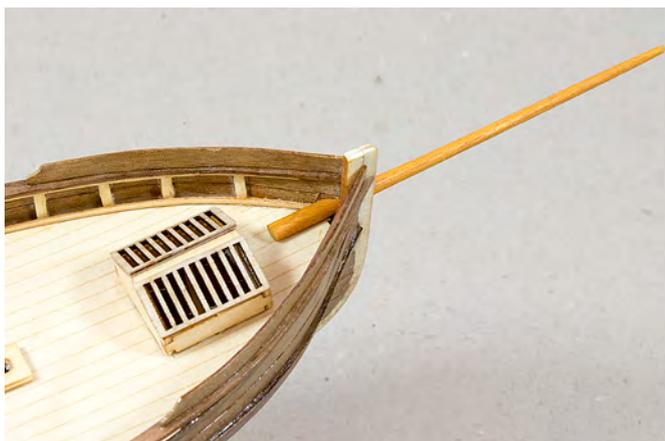
Bohren Sie jetzt ein 3 mm Loch neben den Kiel am Bug, direkt über dem Deck. Dort wird der Bugspriet durch gesteckt und auf das Deck und mit der Bordwand geklebt. Nach dem Sie das vordere Oberlicht (Position 14) zusammengebaut haben, können Sie es hinter dem Bugspriet auf das Deck kleben.
