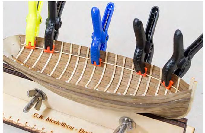
Dann wird auf die Decksstützleiste, an jeden Spant, eine Decksbalken 2 x 2 mm aus Position 5 geklebt. Beginnen Sie an Spant 9 hin zum Bug und dann zum Heck. Falls Ihre Rumpfschale etwas zu weit ist können Sie sie mit ein paar Gummiebänder auf die richtige Breite bringen. Die länge der Decksbalken entnehmen Sie bitte der Tabelle.
