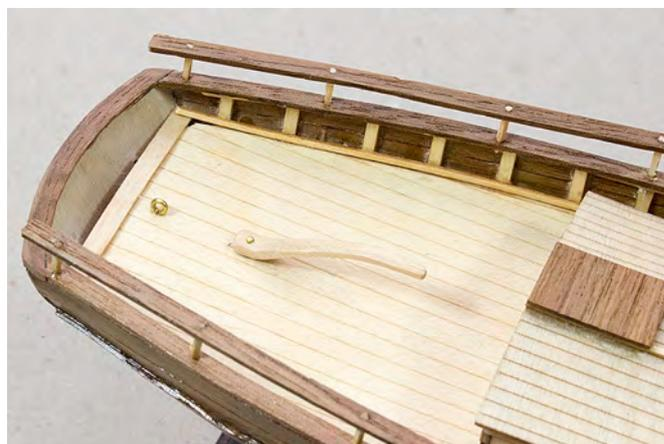
Entnehmen Sie der Position 10 die Ruderpinne und versäubern sie, diese muss jetzt noch in Form geschliffen werden (siehe Zeichnung auf Bogen 2). Durch das Bodenstück der Ruderpinne bohrt man mittig ein 0,8 mm Loch, in dieses wird ein 0,7 x 7 mm Messingnagel geklebt.
