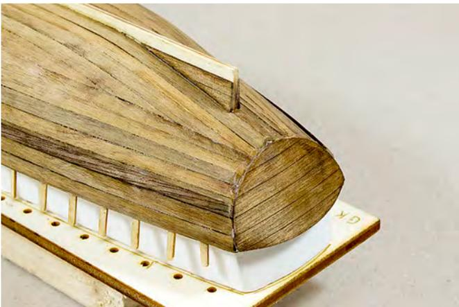
Nun wird die Bergeleiste aus Position (6) gesetzt. Auf der dritten Planke an der Unterkante der zweiten Planke anbringen und verschleifen. Jetzt wird auch das Kielfüllstück beidseitig beplankt, sowie der Heckspiegel.
