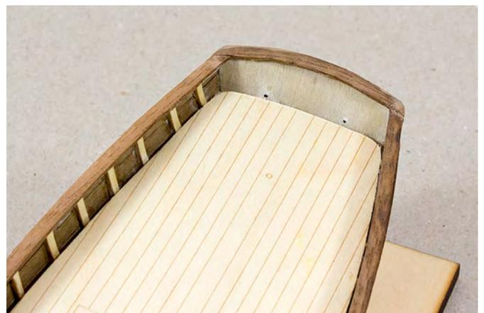
Als nächstes wird ein Wasserpass aus Position 8 an die Spanten auf das Deck geklebt.
