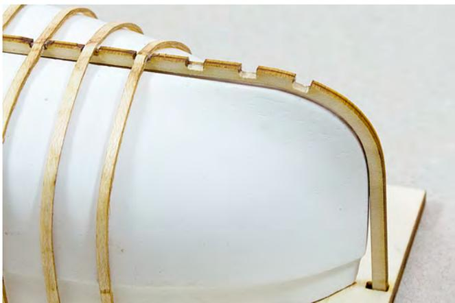
kurz andrücken, Spant ablängen und in die gegenüberliegende Bohrung stecken. Nun mit der Formspitze, am Kiel beginnend, den Spant sanft an die Form drücken, Spant eventuell mit einer Pinzette nachspannen. Die Mittelspanten müssen nicht im Kielbereich auf der Form aufliegen.
