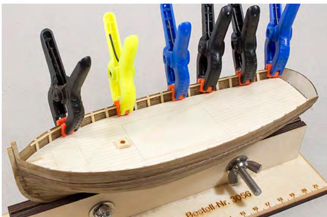
Bevor man die Handläufe aus Position 9 auf die Handlaufstützleiste und Bordwand klebt muss man sie vorbiegen.
