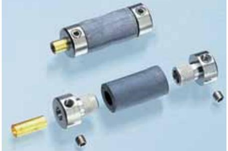
Für Wellenanschlüsse von 4 oder 3,2 mm auf 3 oder 4 mm (mit Reduzierstück). Hohe Laufruhe durch kräftige Gummiverbindung. Mit Edelstahl-Gewindestiften. Gesamtlänge 28 mm
