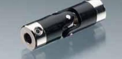
Die klassische Kreuzgelenkkupplung aus Kunststoff mit Messing-einsätzen, Mittelstück aus Metall und Edelstahl-Gewindestiften. Für Wellen mit 4 mm und 3 bis 3,2 mm Ø (mit Reduzierstück) Gesamtlänge 38 mm
