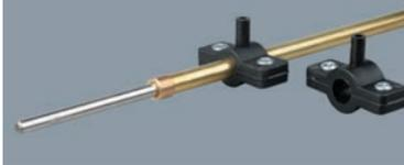
Diese praktischen Öl-Füllhilfen können ganz einfach um Ihr Stevenrohr gelegt und festgeschraubt werden. Dann bohrt man das Einfüllloch durch den Öler in das Stevenrohr. Nun kann ein Stück Silikon-schlauch zum Einfüllen von Öl oder Fett aufgesteckt werden.
