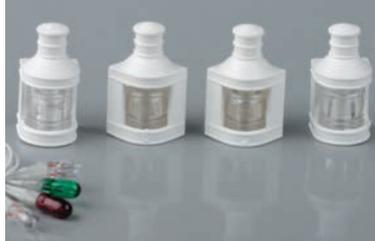
Für die originalgetreue Beleuchtung von größeren Schiffsmodellen, 6 V/50 mA, rechts grün, links rot, vorne und hinten klar, Glühlampen mit 800 mm Litzenlänge, Lampengehäuse Ø10 x 20 mm
