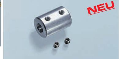
Präzise starre Kupplungen zur Verbindung verschiedener Wellendurchmesser aus Aluminium mit ISK Gewindestiften. Außen-Durchm. 11 x 17 mm
