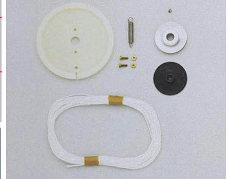
Dient zum proportionalen Schwenken von Kränen, Löschmonitoren, Geschützen usw. Durch das Übersetzungsverhältnis (3:1) wird der Schwenkbereich eines normalen Servos von 90 auf 270° vergrößert. Die große Scheibe mit 60 mm Durchmesser wird auf dem Servo befestigt, die kleine Scheibe an dem zu drehenden Gegenstand. Sehr einfacher Einbau, auch nachträglich.
