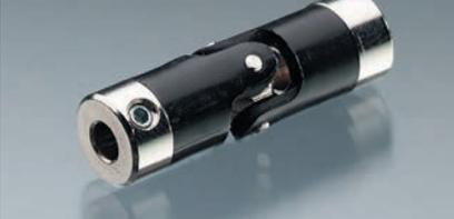
Die klassische Kreuzgelenkkupplung aus Kunststoff mit Messing-einsätzen, Mittelstück aus Metall und Edelstahl-Gewindestiften. Für Wellen mit 4 mm und 3 bis 3,2 mm Ø (mit Reduzierstück) Gesamtlänge 38 mm
