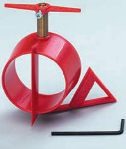
Bewegliche Kortdüse für Schiffsschrauben bis 50 mm Durchmesser geeignet. Durch die Tunnelwirkung am Propeller wird eine sehr hohe Wendigkeit des Modells erzielt.
