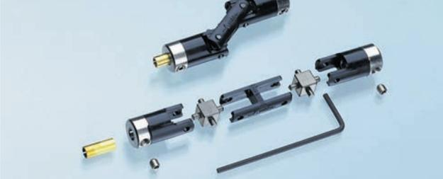
Doppel-Kreuzgelenkkupplung für Schiffsantriebe mit Wellenversatz. Wellenversatz-Ausgleich ca. 2 mm. Für Wellen mit 4 mm und 3 bis 3,2 mm Ø (mit Reduzierstück)
