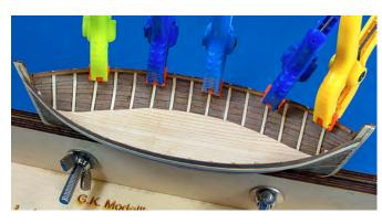
Bevor man die Handläufe aus Position 7 auf die Handlaufstützleiste und Bordwand klebt muss man sie vorbiegen.
