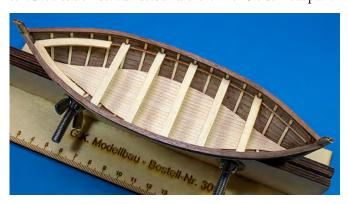
Die Dolden aus Position 1 werden aus der Platine getrennt und auf den Handlauf geklebt.
