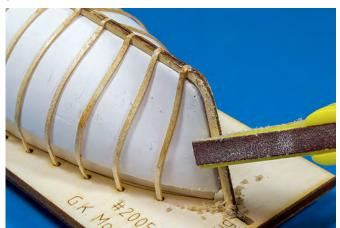
Sind alle Spanten gesetzt und angepasst, muss im Bug- und Heckbereich eine Sponung eingearbeitet werden. Schleifen Sie dazu die Kanten des Kielteils im Bug- und Heckbereich mit einer Schleiffeile oder schneiden Sie die Kanten mit einem Messer weg. In diese Sponung (Kerbe) können die Planken (Position 4) nahtlos eingreifen. Das zweite Kielleiste auf dem ersten ausrichten, festkleben und mit der Formspitze andrücken.
