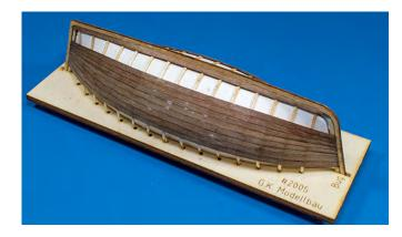
Nach der fünften oder sechsten Planke sollte man vom Kiel aus beplanken, so erreichen Sie einen sauberen Abschluss am Kiel. Nun sollten Sie Klebstoffreste mit der heißen Form- und Biegespitze entfernen.
