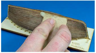
Der Vorgang wird mit feinerem Schleifpapier und nur noch stellenweise Leim, bis zur Fertigstellung des Rumpfes wiederholt, der Schleifstaub verbindet sich mit dem Weißleim und füllt so die Lücken.
