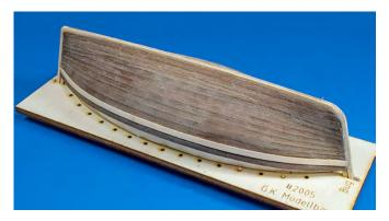
Vor dem Innenausbau sollten Sie die Bergeleisten (Position 5) auf die Zweite Planke kleben und verschleifen.
