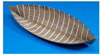
Aber Vorsicht, die Beplankung ist dünn und schnell durchgeschliffen. Jetzt können Sie die Spanten bündig mit der Bordwand abschneiden und die Spanten inklusive der Bordwand mit einer Schleiffeile überschleifen.
