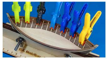
Aus Position 8 nehmen Sie zwei 0,6 x 1 mm Leisten und kleben sie innen auf die Spanten. Mittig der dritten Planke, am Heck beginnend bis zum Bug ein (als Ruderbankstützleisten).
