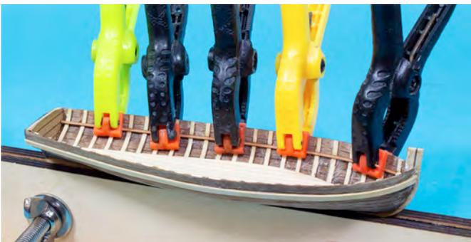
Die achterne Sitzbank aus Position 1 wird angepasst und auf die Ruderbankstützleisten ins Heck geklebt. Trennen Sie die Ruderbänke aus der Platine (Position 9) und versäubern die Schnittkanten. Die Position der Ruderbänke entnehmen Sie dem Bauplan.
