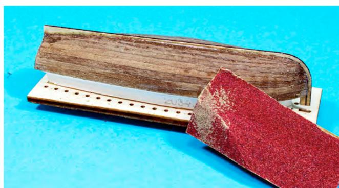
Aber Vorsicht, die Beplankung ist dünn und schnell durchgeschleift. Jetzt können Sie die Spanten bündig mit der Bordwand abschneiden und die Spanten inklusive der Bordwand mit einer Schleiffeile überschleifen.
