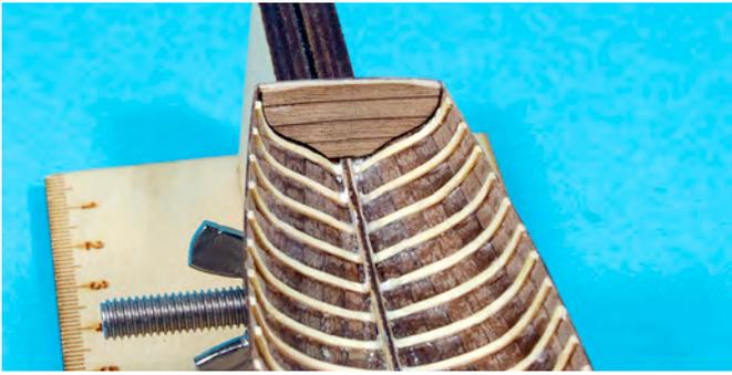
Das Bodenbrett aus Position 10 wird auf den Kiel und die Spanten einkleben.
