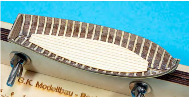
Aus Position 8 nehmen Sie zwei 0,6 x 1 mm Leisten und kleben sie innen auf die Spanten. Unterkante der zweiten Planke, am Heck beginnend bis zum Bug ein (als Ruderbankstützleisten).
