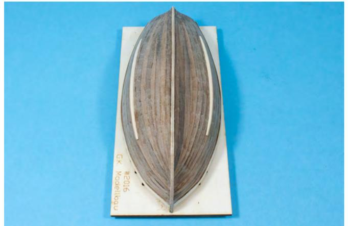
Der Heckspiegel wird noch von innen Beplankung und die überstehenden Spanten abgeschnitten und verschliffen.
