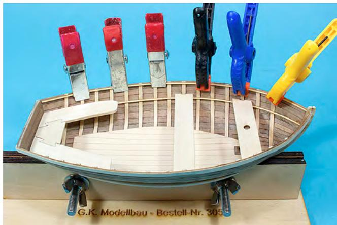
Bevor man die Handläufe aus Position 7 auf die Handlaufstützleiste und Bordwand klebt muss man sie vorbeugen.
