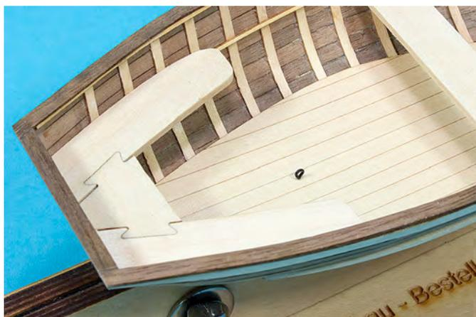
Die Klampen K1 und K2 aus Position 14 werden links und rechts zwischen SPant 14 und 15 unter den Handlauf an die Bordwand geklebt.
