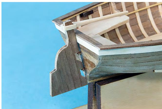
Halten Sie das Steuerruder an das Heck und markieren die Position der Fingerlinge. Bohren Sie jetzt zwei Löcher (0,6 mm), in den Heckspiegel, für die Kupfer-Stiftösen aus Position 15, in diese werden dann die Fingerlinge eingehängt.
