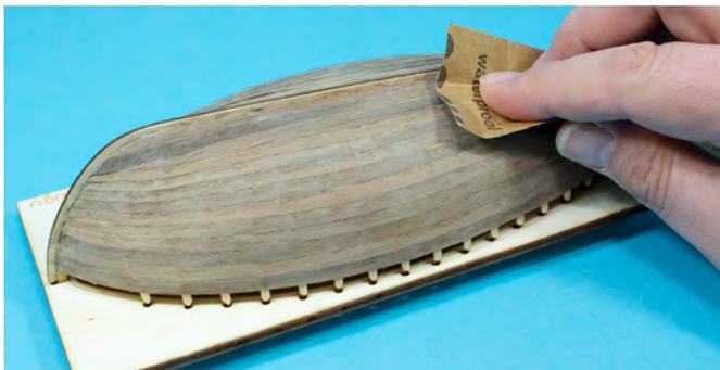
Der Vorgang wird mit feinerem Schleifpapier und nur noch stellenweise Leim, bis zur Fertigstellung des Rumpfes wiederholt, der Schleifstaub verbindet sich mit dem Weißleim und füllt so die Lücken. Aber Vorsicht, die Beplankung ist dünn und schnell durchgeschliffen. Versäubern kann man die Rumpfschale von aussen und innen auch mit einer Minibohrmaschine und Stahldrahtbürsten (Bitte eine Schutzbrille tragen).
