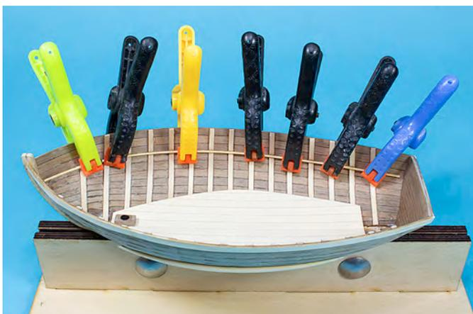
Die achterne Sitzbank aus Position 9 wird zusammengebaut, angepasst und auf die Ruderbankstützleisten ins Heck geklebt. Trennen Sie die Ruderbänke aus der Platine (Position 9) und versäubern die Schnittkanten. Die Position der Ruderbänke entnehmen Sie dem Bauplan.
