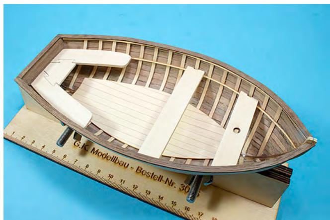
Eine Messingstiftöse (S1) wird von aussen in das Bugkielteil gesetzt, sie sitzt auf Höhe des Übergangs der ersten und zweiten Planke. Nach dem Einkleben der Stiftöse die Öse (Ö1) etwas aufbiegen und in die Stiftöse einsetzen. Dann wieder zubiegen.
