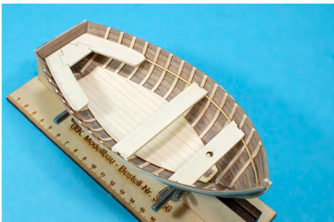
Nun kleben Sie zwei 1 x 1 mm Leisten aus Position 6 bündig zur Bordwand als Handlaufstützleiste ein.
