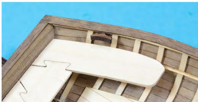
Die Dolden aus Position 14 werden auf den Handlauf in Höhe Spanten 5 und 9 geklebt. Die Ruderbank stützen (Position 1) werden auf die Ruderbänke und Spanten geklebt (Zeichnung Bogen 2)
