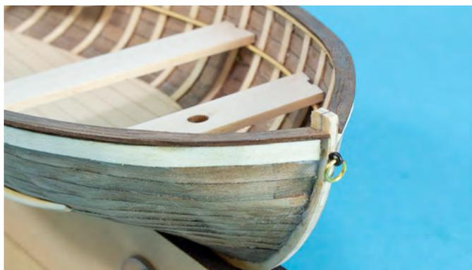
Eine zweite Messingstiftöse (S2) wird mittig in das Bodenbrett, auf Höhe Spant 11, geklebt.
