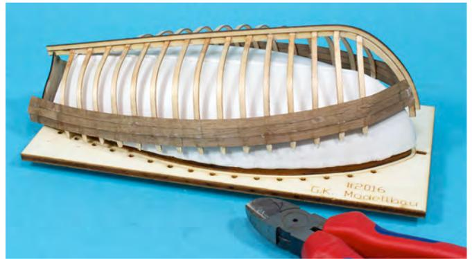
versäubert, Gips und Klebstoffreste entfernt. Dieses geschieht am Besten mit einer Mini-Bohrmaschine und einer Pinselbürste. Größere Klebstoffreste lassen sich mit der Form- und Biegespitze beseitigen. Nun wieder auf der Form befestigen. Es empfiehlt sich, das Boot zwischendurch immer wieder von der Form zu nehmen, um zu verhindern, dass es festklebt.
