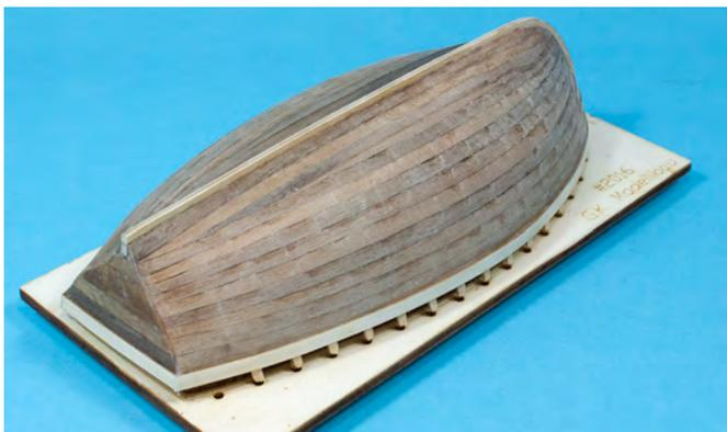
Trennen Sie die Schlingerkiele aus der Platine (Position 5) und versäubern die Schnittkanten mit einer Schleiffeile. Bei den Aussenkanten sollte man die Kanten brechen um ein schnittiges Profil zu erhalten. Die Schlingerkiele werden 30 mm vom Kiel aus, mittig auf den Rumpf geklebt.
