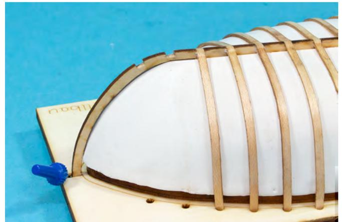
Die Bugspanten müssen auch im Kielbereich eng an der Form liegen, dieses wird durch abschrägen der Einkerbungen erreicht.
