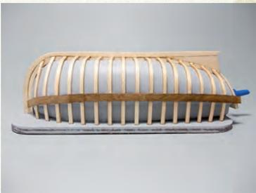
der Form befestigt. Das vordere Ende wird in die Bohrung gesteckt (etwas anspitzen) und ausgerichtet. Das Kielteil und der Heckspiegel werden mit einem Tropfen Kleber verbunden und mit der Form- und Biegespitze angedrückt, damit der Kleber aushärtet. Die Spanten müssen einige Minuten in kaltem Wasser gewässert werden. In der
