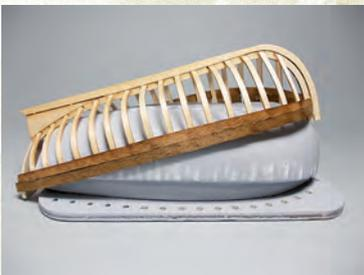
Regel reichen 5-10 Minuten aus. Am Heck beginnend, wird eine Leiste über den Kiel in die Kerbe für die Spanten gelegt. Ein Spantende in die Bohrung stecken, ein Tropfen Kleber in die Kerbe geben, Spant einlegen, mit der warmen Form- und Biegespitze kurz andrücken und in die gegenüberliegende Bohrung stecken. Nun mit der
