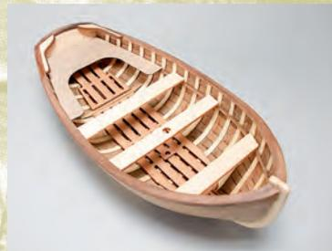
des Rumpfes in der Mitte größer ist als im Bug- und Heckbereich. Beim Arbeitsboot genügt eine leichte Verjüngung der Planken um ca 1,5 mm zum Bug und Heck. Ein praktisches Werkzeug zum Verjüngen der Planken ist der Plankenschneider Bestell-Nr. 3009. Das Setzen der Planken geschieht wechselseitig, einen Tropfen
