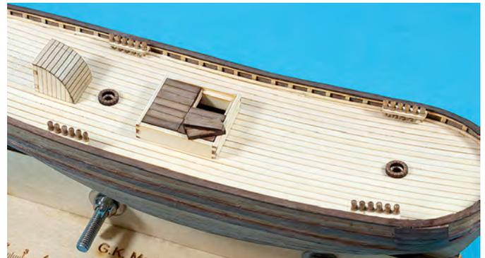
Vor dem Setzen der Knechte müssen erst die Knechtköpfe angefertigt werden, 2 mm vom Kopf aus wird rundum mit einer Vierkantfeile eine V-Nut eingefeilt und der Kopf angefast. Die Knechte (Karte 1, Beutel 22) werden, an Spantposition 4, 8 und 19, auf das Deck und an den Handlauf geklebt.
