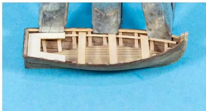
Bevor man die Handläufe aus Position 7 auf die Handlaufstützleiste und Bordwand klebt, muss man sie vorbiegen.
