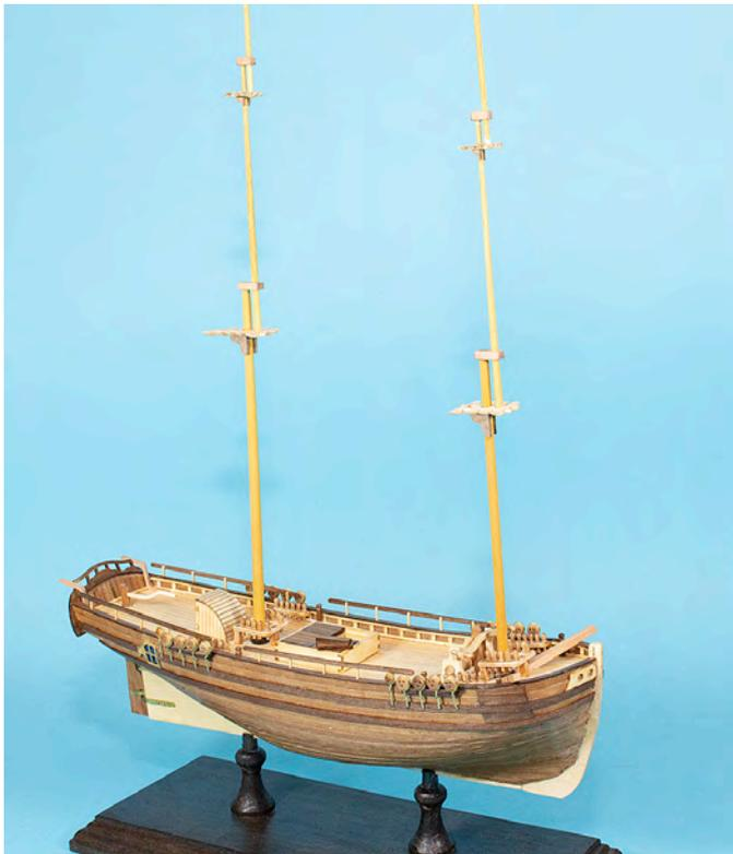
Die Rüsten (Karte 1, Beutel 24) werden, bei Spant 5 und 20, unter den Handlauf an die Bordwand geklebt. Der Messingdraht der Juffern (5 mm Juffern) wird durch die Rüsten gesteckt und dann in einer Bohrung der ersten Bergeleiste verklebt. Die Position der Bohrungen ermittelt man mit einem Faden der von den Sallings, über die Rüsten, zur Bergeleiste gespannt wird. Hinter den Rüsten wird jeweils eine 3,5 mm Juffer mit Messingdraht in die Bergeleiste gesetzt.
