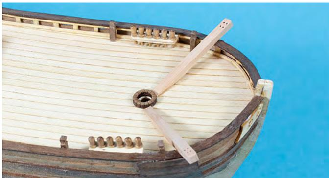
Die Kranbalken (Karte 3, Position 8) beginnen am vorderen Mastfuss über den Handlauf an Spant 3 und ragen ca. 7 mm über
