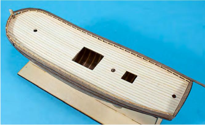
Geben Sie dann Sekundenkleber auf die Handlaufstützleiste und Bordwand und kleben den Handlauf mit der Form- und Biegespitze auf. Beginnen Sie am Bug und arbeiten sich Segmentweise zum Heck vor. Sind die Handläufe rechts und links gesetzt, muss noch die Lücke am Heck (Heckspiegel) geschlossen und der Handlauf im ganzen übergeschliffen werden.
