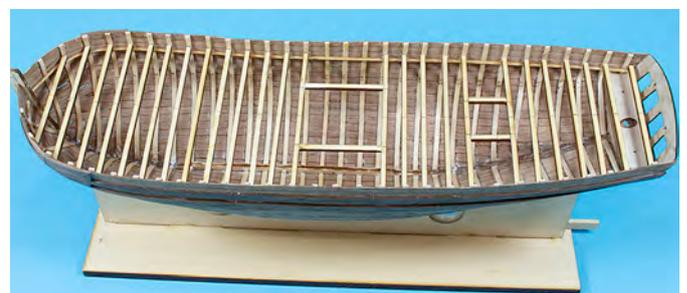
Abschließend werden Decksbalken auf den Spante 16 zu den Längsbalken der Ladeluke gesetzt. Nun können die Mastfischungen (Karte 1, Beutel 20) zwischen die Decksbalken auf Spant 5-6 und 20-21 eingeklebt werden.
