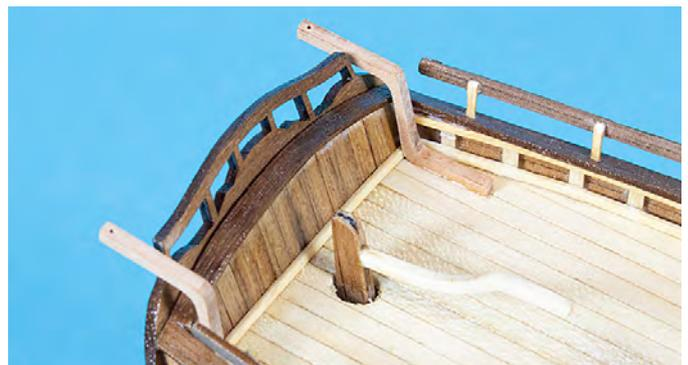
Die Bootsausleger (Karte 1, Beutel 20) werden versäubert, in den längeren Teil wird am Ende jeweils ein 0,8 mm Loch gebohrt. Die Ausleger werden dann mit dem kurzen Ende auf das Deck am Heck geklebt.
