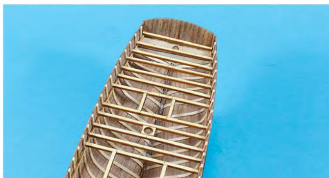
Mit den Leisten aus Decksplanken (Karte 3, Position 9) wird das Deck beplankt. Die erste Planke klebt man entlang der aufgezzeichneten Mittellinie. Die Aussparungen für die Ladeluke und den Niedergang sollte man gleich aussparen und die Mastfischungen gleich wieder freilegen.
