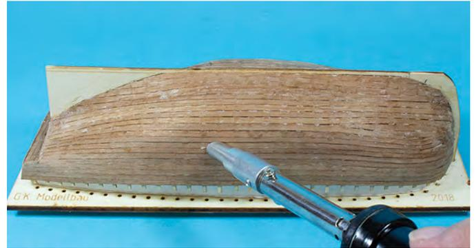
Nun wird der Rumpf abgedichtet, hierzu wird die Rumpfschale wieder auf der Malle befestigt und mit wasserlöslichem Weissleim eingestrichen, mit einem feuchten Tuch grob abgewischt und mit grobem Schleifpapier, Körnung 100-120, überschleift.
