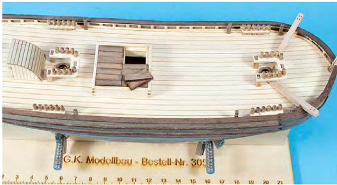
Die U-Förmigen Nagelbänke (Karte 1, Beutel 22) werden aus der Platine ausgetrennt, versäubert und mit Belegnägeln (Karte 1, Beutel 25) versehen. Die Nagelbankstützen versäubern und in die Nagelbänke einkleben. Die Nagelbänke können dann über die Mastfüsse auf das Deck geklebt werden.
