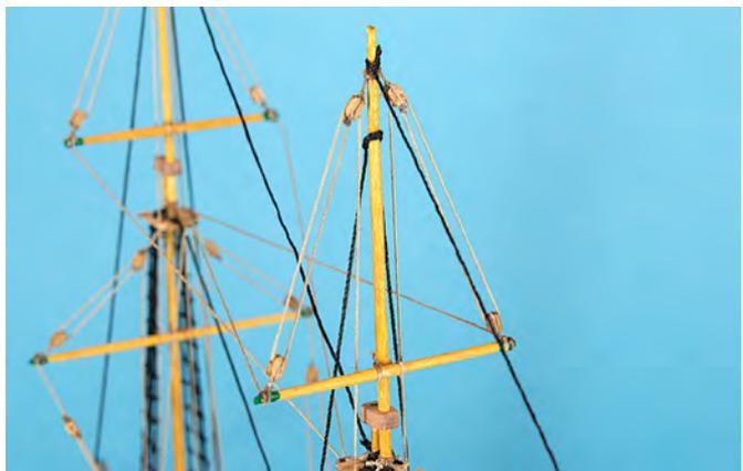
Für die Ausrichtung der Rahen sind noch weitere Takelarbeiten erforderlich. Bei den Marsrahen laufen jeweils zwei Tauen von den Rahenden zu einem Doppelblock des gegenüberliegenden Mastes. Bei der Fockmast-Marsrah (VII) laufen die Tauen durch den Doppelblock B41 am Großmast und werden an den Nagelbänken N1 bzw. N3 festgemacht. Bei der Großmast-Marsrah (X) werden die Tauen durch den Doppelblock B22 am Fockmast geführt und werden an den Nagelbänken N2 bzw. N4 festgemacht.
