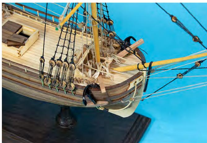
Das Beiboot (siehe gesonderte Anleitung) wird mit den Stiftösen A6 und A7 (Karte 1, Beutel 20) versehen. An die zwei Einerblöcke werden die Takelhaken (Karte 1, Beutel 20) angeknötet. Die Blöcke werden mit den Takelhaken in die Stiftösen A6 und A7 eingehängt. An die Bootsausleger wird jeweils ein Tau hinter die Bohrung angeknötet. Das Tau läuft durch die Blöcke im Beiboot dann zurück zum Bootsausleger durch die Bohrung und wird im Bogen des Bootsauslegers festgemacht.
