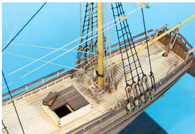
Für die Anker müssen die Ankerstöcke (Karte 1, Beutel 18) an der Unterseite etwas abgeflacht werden (siehe Zeichnung Bogen 2). Die Anker werden mit dem Ankerstock und der 3 mm Öse versehen und mit dem Ankertau (Karte 1, Beutel 18) aufgetakelt.
