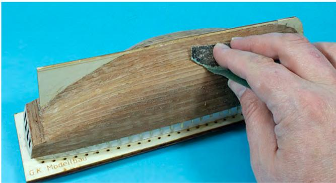
Nach dem Verschleifen werden die Bergeleisten (Karte 2, Position 7) auf den Rumpf geklebt. Die erste Bergeleiste wird auf den dritten Plankengang geklebt. Die Zweite Bergeleiste (Karte 2, Position 6) wird mit 4 mm Abstand zur ersten Bergeleiste aufgeklebt.
