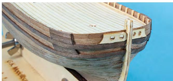
Bevor man die Handläufe aus Karte 3, Position 13 auf die Handlaufstützleiste und Bordwand klebt muss man sie vorbiegen. Wässern Sie den Handlauf und fixieren ihn dann auf einer glatten Fläche mit drei kleinen Nägeln oder Stoßnadeln. Erwärmen Sie dann den Handlauf mit der Form- und Biegepitze und ziehen den Handlauf mit der anderen Hand in die Biegerichtung. Wiederholen Sie das Ganze, weitere Stoßnadeln können für die Formgebung hilfreich sein, bis der Handlauf zur Bordwand passt.
