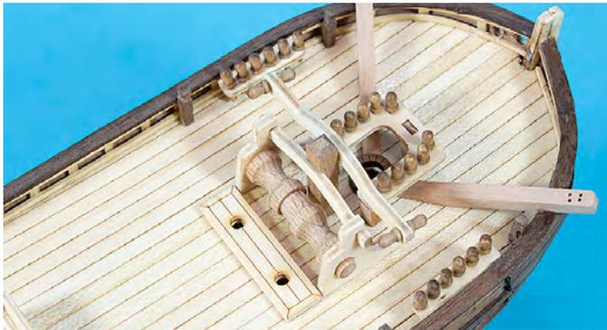
Nun kann das Spill mit der Kabelgat-Abdeckung auf das Deck geklebt werden. Die Löcher in der Kabelgat-Abdeckung überträgt man mit einem 2 mm Bohrer durch das Deck.
