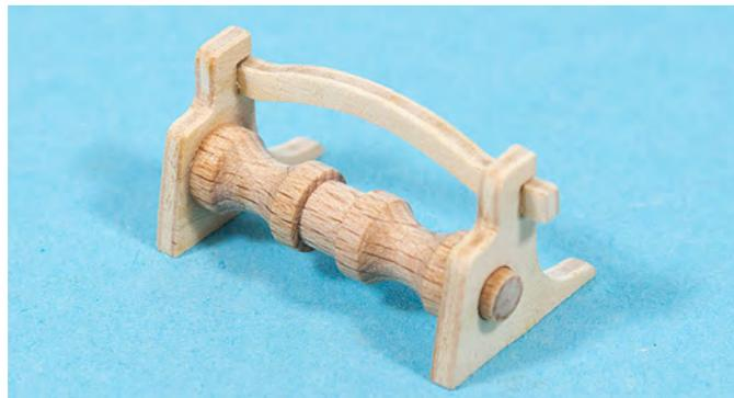
Nun wird der Knecht angepasst, stellen Sie ihn hinter das Spill und zeichnen die Position des Querbalkens an. Feilen Sie dann eine Aussparung in den Knecht damit der Querbalken in ihn einrastet. Der Knecht wird jetzt auf ca. 22 mm gekürzt und am oberen Ende angefast.
