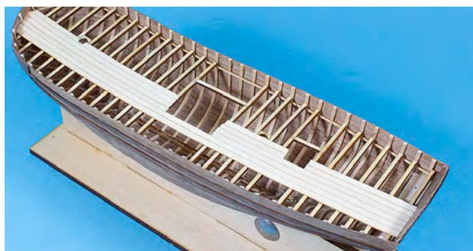
Die Leisten aus Karte 4, Position 17 werden als Wasserpass an die Spanten und auf Deck geklebt
