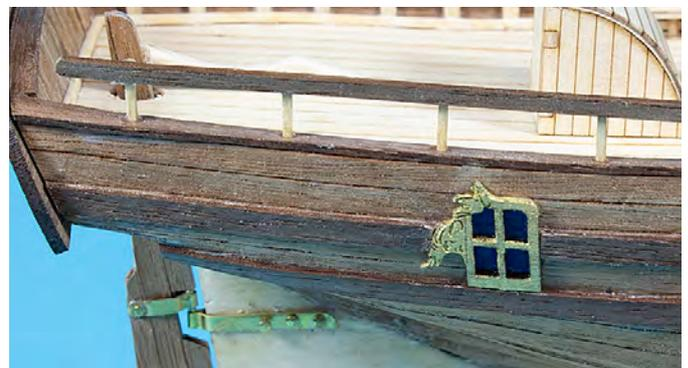
Die blinden Seitenfenster werden auf Höhe Spant 25 aufgeklebt. Das Fenster steht unten auf der zweiten Bergeleiste, die Fensterkontur wird auf der ersten Bergeleiste angezeichnet. Die Bergeleiste dann entsprechend ausgeklinkt und das Fenster aufgeklebt.
