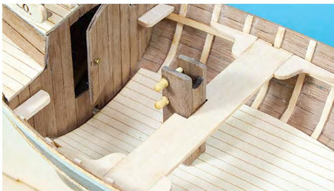
Bevor man die Handläufe aus Position 6A auf die Bergeleiste und Bordwand klebt muss man sie vorbiegen.
