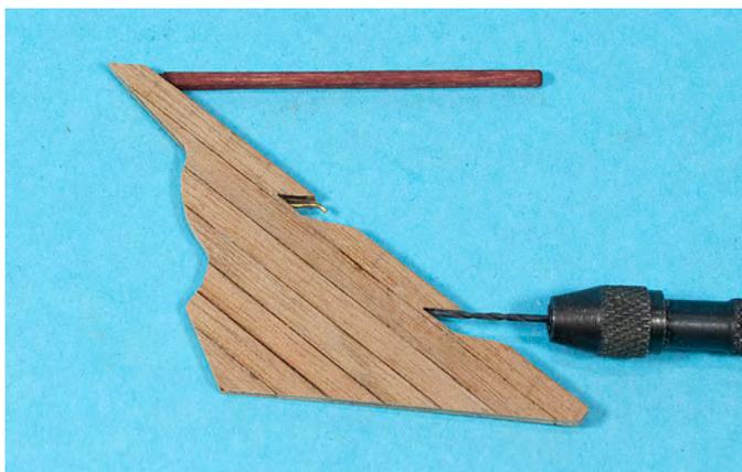
Bohren Sie in die unteren Aussparungen zwei 0,8 mm Löcher und kleben dort die Fingerlinge ein. Die Fingerlinge biegen Sie aus dem Messing-Draht aus Position 15. Wenn Sie einen der Fingerlinge etwas länger lassen, lässt sich das Steuerruder leichter einhängen.
