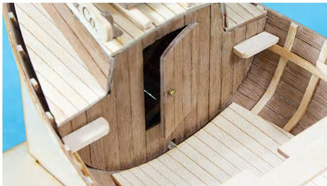
Als nächstes wird das Heckschott Position 12 beplankt, angepasst und vor den Spant 20 eingeklebt.
