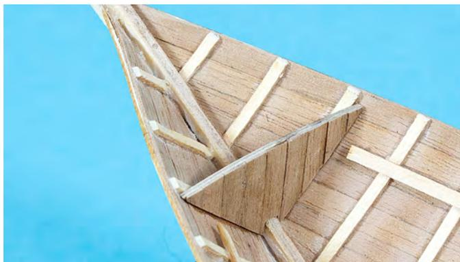
Auch die Heckschottabdeckung Position 12 wird mit der Decksbeplankung aus Position 4 beplankt und dann auf das Heckschott und den Kiel eingeklebt.
