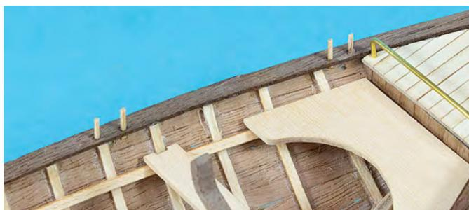
Die Dolden aus Position 15 werden versäubert und auf den Handlauf, zwischen Spant 8-9, geklebt.
