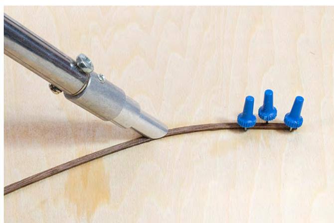
Wässern Sie den Handlauf aus Position 6A und fixieren ihn dann auf einer glatten Fläche mit drei kleinen Nägeln oder Stoßnägeln. Erwärmen Sie dann den Handlauf mit der Form- und Biegepitze und ziehen den Handlauf mit der anderen Hand in die Biegerichtung. Wiederholen Sie das ganze bis der Handlauf zur Bordwand passt. Dem Bausatz liegen vier Leisten für den Handlauf bei, Sie benötigen nur zwei, also keine Angst vor Fehlern.
