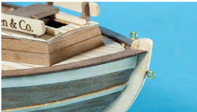
Nun müssen auf jeder Seite vier Bohrungen in die Bergeleiste gesetzt werden. Bohren Sie mit einem 1 mm Bohrer Löcher in die Bergeleiste zwischen die Spanten 9-10, 14-15, 15-16 und 19-20.
