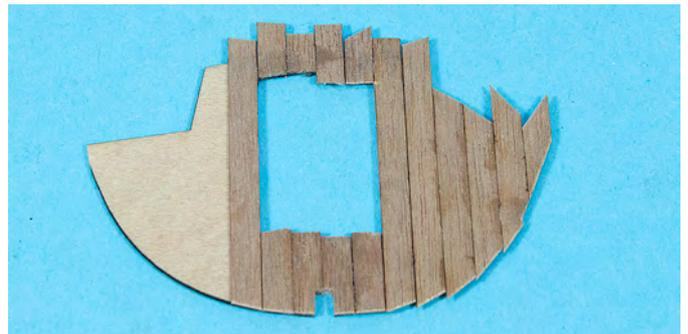
Die Tür wird gesondert beplankt, der Messingnagel 1 x 13 mm wird als Türgriff eingeklebt und dann gekürzt. Der Stoffrest aus Position 12 wird auf die Rückseite des Bugschotts und der Tür als Scharnier geklebt. Das Bugschott wird dann direkt hinter den Spant 6, an den Spant in den Rumpf geklebt.
