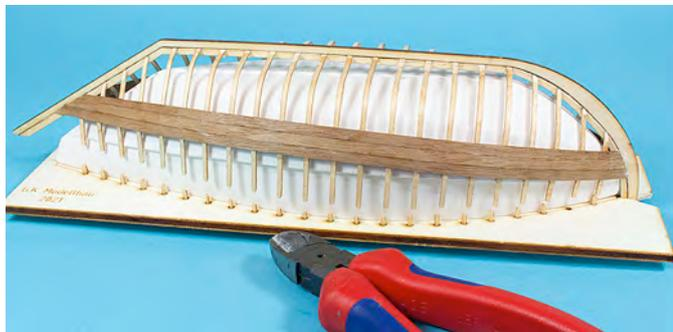
Am Besten mit einer Mini-Bohrmaschine und einer Pinselbürste, tragen Sie beim Arbeiten mit der Pinselbürste bitte eine Schutzbrille.. Größere Klebstoffreste lassen sich mit der Form- und Biegespitze beseitigen.
