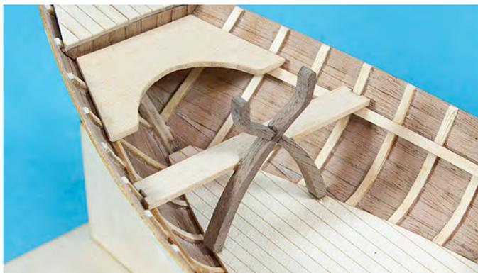
Der Mastköcher Position 14 wird aus der Platine getrennt, versäubert und zusammengebaut (siehe Zeichnung Bogen 2). Die Belegnägel werden etwas gekürzt und in den Mastköcher eingeklebt. Der Mastköcher wird in die Aussparung der ersten Ruderbank und auf das Bodenbrett geklebt. Bitte beachten Sie dabei die Ausrichtung.
