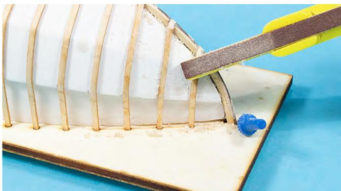
Die Bug- und Heckspanten müssen auch im Kielbereich eng an der Form liegen, dieses wird durch abschrägen der Einkerbungen erreicht. Sind alle Spanten gesetzt und angepasst, muss im Bugbereich eine Sponung eingearbeitet werden. Schleifen Sie dazu die Kanten des Kielteils im Bug- und Heckbereich mit einer Schleiffeile oder schneiden Sie die Kanten mit einem Messer weg.
