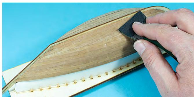
Der Vorgang wird mit feinerem Schleifpapier und nur noch stellenweise Leim, bis zur Fertigstellung des Rumpfes wiederholt, der Schleifstaub verbindet sich mit dem Weissleim und füllt so die Lücken.
