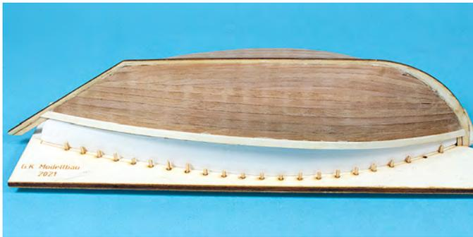
Die Scheuerleiste Position 6A wird in einem Bogen aufgeklebt. vorne und hinten 13 mm in der mitte 19 mm von der Bordwand aus.
