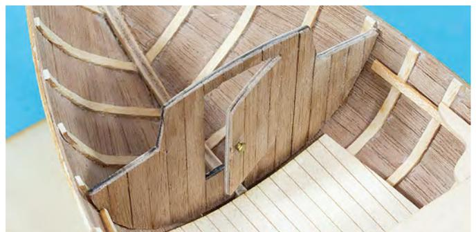
Die Bugschottabdeckung aus Position 12 wird mit der Decksbeplankung aus Position 4 beplankt und dann auf das Bugschott und den Bugkiel eingeklebt.
