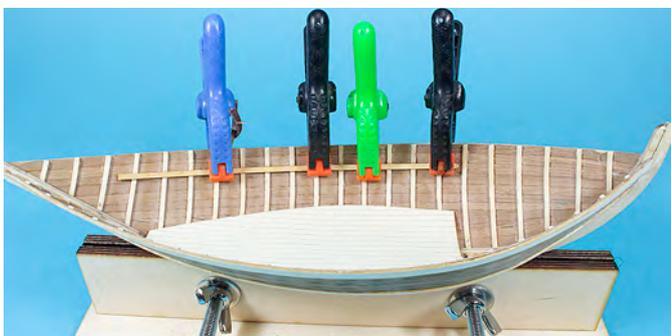
Die Ruderbänke aus Position 6 werden aus der Platine getrennt und versäubert. Die Mastruderbank wird bei Spant 10 auf die Ruderbankstützleiste geklebt und die zweite Ruderbank bei Spant 16. Bitte achten Sie bei der Mastruderbank auf die Ausrichtung, die Aussparung muss Richtung Bug zeigen. Die Mastruderbank wird dann noch mit den Mastbankknieen (Position 12) abgestützt. Diese werden an die Ruderbank und die Spanten geklebt.
