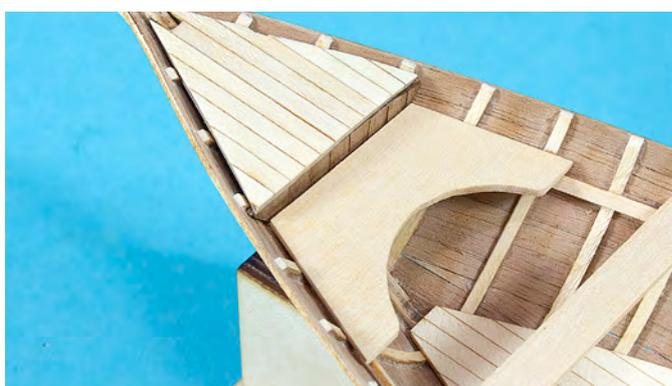
Die Baumauflege Position 14 wird versäubert und an der Überblattung verklebt. Die Baumauflege wird mittig an die zweite Ruderbank und auf das Bodenbrett geklebt.
