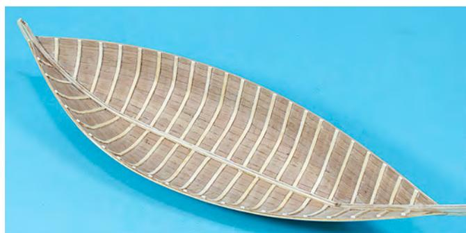
Jetzt können Sie die Spanten bündig mit der Bordwand abschneiden und die Spanten inklusive der Bordwand mit einer Schleiffleile überschleiffen.
