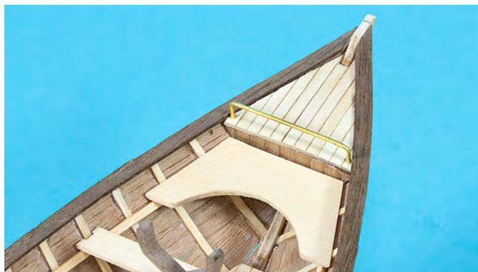
Die Belegpinne werden aus den 1 x 1 Material Position 13 hergestellt. Brechen Sie dazu die Kanten der Leisten und versäubern die Schnittkanten. Jeweils zwei Pinne werden in den Handlauf zwischen die Spanten 15-16 und 19-20 gesetzt. Bohren Sie dazu 1 mm Löcher und kleben die Pinne ein. Lassen Sie die Pinne erstmal etwas länger und bringen sie dann auf eine Länge von 5 mm.
