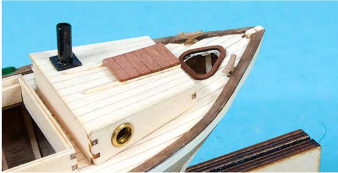
Der Leuwagen wird aus einem 0,8 mm Messingdraht (Position 12) gebogen (siehe Zeichnung Bogen 2). Der Leuwagen wird dann in zwei Bohrungen in das Deck geklebt.
