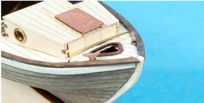
Mit den Scharnierbändern für die vordere Ladeluke wird der Decksausbau abgeschlossen. Schneiden Sie von dem Bleiband (Position 14) 2,5 mm breite Streifen ab. Kleben Sie diese dann auf die Ladeluke mit einem Abstand von 8 mm.
