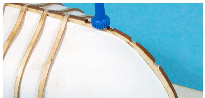
Sind alle Spanten gesetzt und angepaßt, muß im Bugbereich eine Sponung eingearbeitet werden. Schleifen Sie dazu die Kanten des Kielteils im Bugbereich mit einer Schleiffeile oder schneiden Sie die Kanten mit einem Messer weg.
