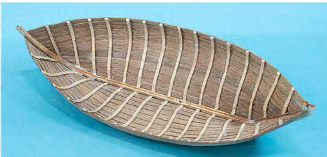
Bevor der Innenausbau beginnt setzt man die Rumpfschale nochmal auf die Malle und klebt die Scheuerleiste (Position 5) auf die oberste Planke (Bündig zur Bordwand).
