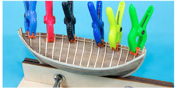
Dann wird auf die Decksstützleiste ein Decksbalken 1,5 x 2 mm aus Position 6 geklebt. Beginnen Sie an Spant 6 hin zum Bug und dann zum Heck. Nicht auf alle Spanten wird ein Decksbalken gesetzt. Falls Ihre Rumpfschale etwas zu weit ist können Sie sie mit ein paar Gummiebänder auf die richtige Breite bringen. Die Länge der Decksbalken entnehmen Sie bitte der Tabelle. Der Decksbalken an Spant 10 wird jeweils links und rechts mit einem weiteren Decksbalken verstärkt.
