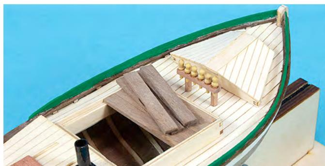
Aus der selben Platine wie die Nagelbank werden die Rudernechte getrennt und versäubert. Nach der Montage werden diese jeweils mittig, links und rechts von der grossen Ladeluke, an den Handlauf auf das Deck geklebt.
