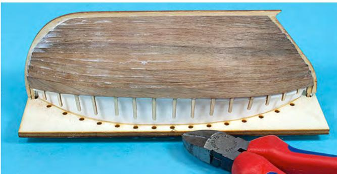
Schneiden Sie die Überstehenden Spanten bündig mit der Bordwand ab und verschleifen die Spanten mit der Bordwand um eine saubere Auflagefläche zu erhalten. Nun können Sie die Rumpfschale auch von innen versäubern.
