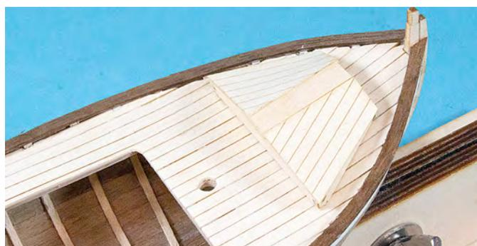
Die Ladeluken haben einen äußeren und inneren Rahmen, bauen Sie zuerst den äußeren Rahmen zusammen. Passen Sie dann den inneren Rahmen an und kleben ihn in den äußeren Rahmen.
