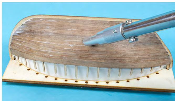
Versäubern kann man die Rumpfschale von aussen und innen auch mit einer Minibohrmaschine und Messingdrahtbürsten (Bitte eine Schutzbrille tragen).
