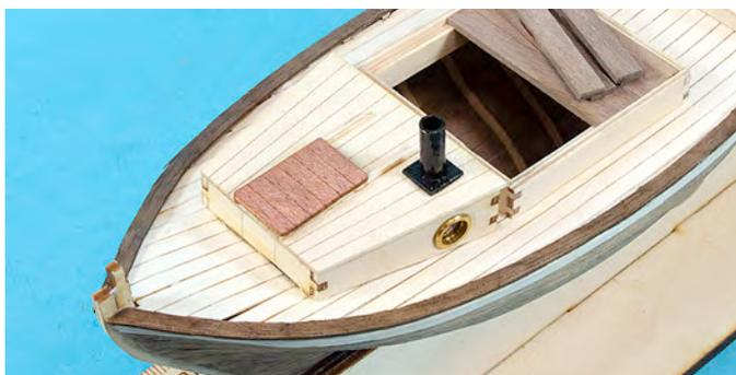
Der Plichtrahmen (Position 12) wird zwischen den Decksbalken auf Spant 13-14 und Spant 15 auf das Deck gelegt und innen angezeichnet. Nun kann man eine Aussparung in das Deck schneiden. Am einfachsten ist es erstmal entlang der Kontour Bohrungen zu setzen und dann die Zwischenräume mit einem Messer zu durchtrennen. Der Plichtrahmen wird dann auf das Deck geklebt. Der Plichtrahmen haben wir in diesem Fall mit einer Teaklasur gebeizt.
