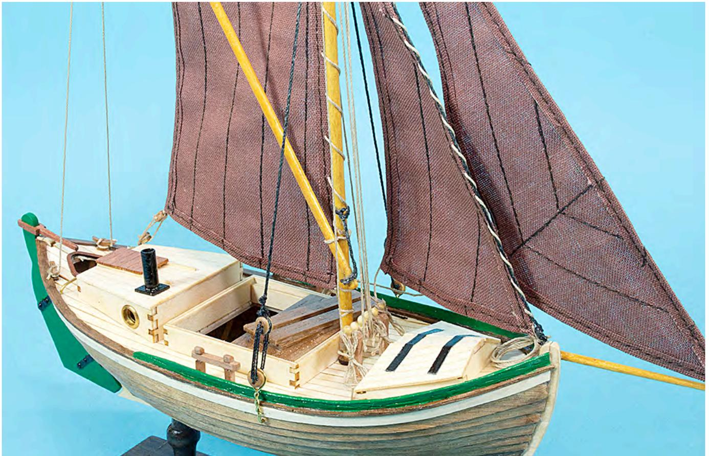
An die Topsegelrute wird ein Tau angeknüpft dieses läuft durch den Block B2 und wird an der Nagelbank festgemacht. Die Ecke 8 wird an der Hauptsegelrute angeknüpft. Das Tau von der 7 wird wieder an der Nagelbank festgemacht. Zum Schluß werden zwei Tauen am Ende der Hauptsegelrute angeknüpft und an den Klampen K1 und K2 festgemacht.
