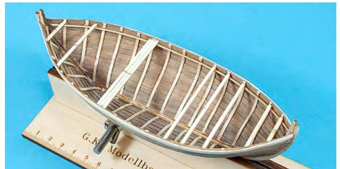
Nach dem die Decksbalken gesetzt sind, sollte man die Mittellinie auf den Decksbalken anzeichnen. Das erleichtert den Einbau der Luken und den späteren Einbau des Decks. Nun können die Längsbalken zwischen den Decksbalken eingesetzt werden.
