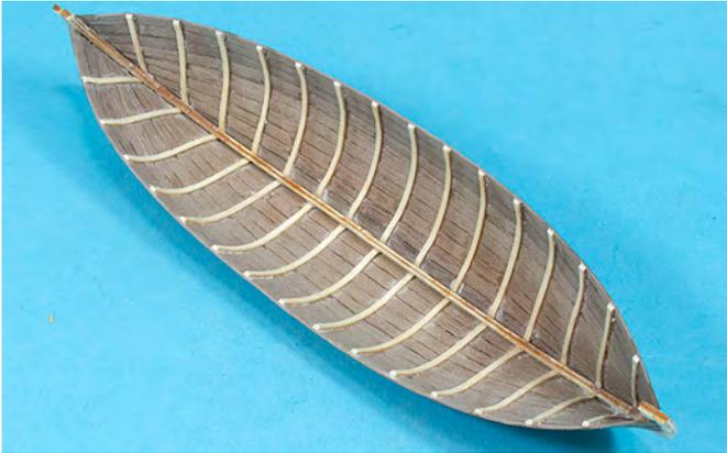
Jetzt können Sie die Spanten bündig mit der Bordwand abschneiden und die Spanten inklusive der Bordwand mit einer Schleiffeile überschleifen.
