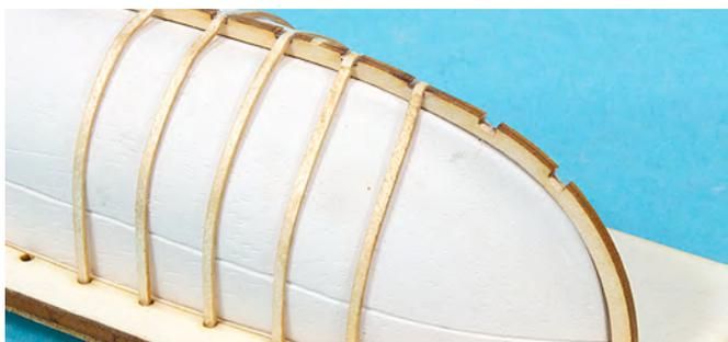
Sind alle Spanten gesetzt und angepasst, muss im Bug- und Heckbereich eine Sponung eingearbeitet werden. Schleifen Sie dazu die Kanten des Kielteils und Achtersteven im Bug- und Heckbereich mit einer Schleiffeile oder schneiden Sie die Kanten mit einem Messer weg.
