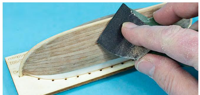
Der Vorgang wird mit feinerem Schleifpapier und nur noch stellenweise Leim, bis zur Fertigstellung des Rumpfes wiederholt, der Schleifstaub verbindet sich mit dem Weissleim und füllt so die Lücken. Aber Vorsicht, die Beplankung ist dünn und schnell durchgeschliffen.
