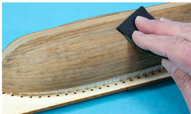
Nach dem Verschleifen werden die Bergeleisten (Karte 2, Position 5) auf den Rumpf geklebt. Die erste Bergeleiste wird an die Unterkante der dritten Planke geklebt. Die zweite Bergeleiste (Karte 2, Position 5) wird mit 4 mm Abstand zur ersten Bergeleiste aufgeklebt.
