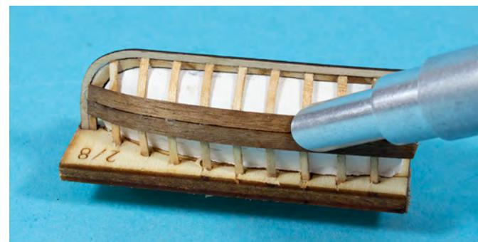
Die Planken anfeuchten, einen kleinen Tropfen Modellbau-Kleber auf den Spant geben, Planke ansetzen und mit der Formspitze andrücken. Sind rechts und links je drei Planken angebracht, kann das Boot erstmals von der Form gelöst werden. Dieses geschieht, indem man die Spanten entlang der Trennlinie durchtrennt, das Boot am Bug und Heck vorsichtig ziehend von der Form nimmt, erstmals versäubert, Gips und Klebstoffreste entfernt.
