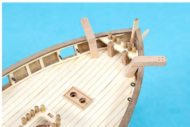
In die Spilltrommel (Beutel 23) werden die sechs Rippen sowie die sechs Sparren eingeklebt. Die Sparren müssen dazu aus der Platine getrennt und die Kanten etwas angefast werden. Das Spill wird dann mittig zwischen der Ladeluke und zweiter Mastnagelbank auf das Deck geklebt.
