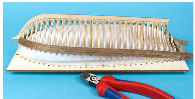
Sind rechts und links je drei Planken angebracht, kann der Rumpf erstmals von der Form gelöst werden. Dieses geschieht, in dem man die Spanten über der Bodenplatte durchtrennt, das Boot am Bug und Heck vorsichtig ziehend von der Form nimmt, erstmals
