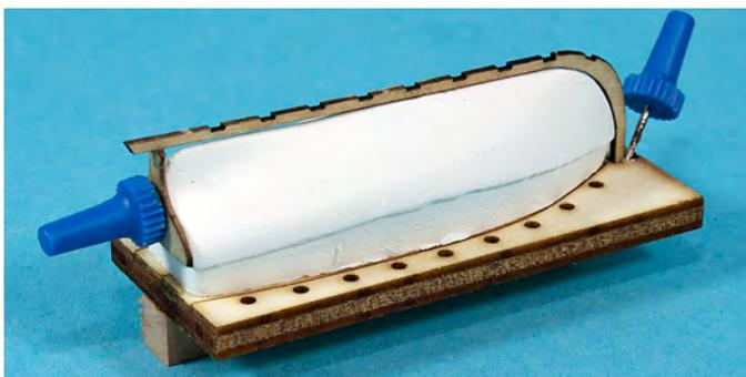
Nun einen Spant über den Kiel in die bereits ausgelaserte Aussparung legen, ein Spantende in die Bohrung stecken, Tropfen Holzmodellbau-Kleber in die Kerbe, Spant einlegen, mit Form- und Biegespitze am Klebepunkt kurz andrücken, Spant ablängen und in die gegenüberliegende Bohrung stecken.
