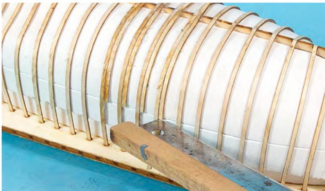
Jetzt müssen wir im Bugbereich die Kanten des ersten Kielteiles mit einem Messer oder Schleiffeile entfernen (nach aufkleben des zweiten Kielteiles entsteht eine Sponung, (Kerbe) in die die Planken eingesetzt werden).
