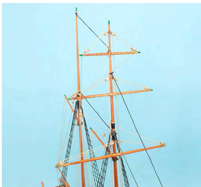
Für die Ausrichtung der Rahen sind noch weitere Takelarbeiten erforderlich. Bei der Marsrah laufen jeweils zwei Tauen von dem Rahende durch den Doppelblock B2 und werden an der Nagelbank N6 festgemacht. An die Grossrah werden an den Enden noch zwei zusätzliche Tauen angeknotet und an den Nagelbänken N1 und N3 festgemacht.
