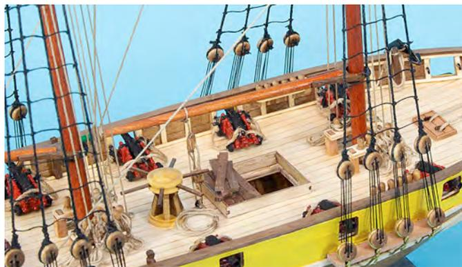
Das Tau läuft durch die Blöcke im Beiboot, dann zurück zum Bootsausleger durch die Bohrung und wird im Bogen des Bootsauslegers festgemacht.
