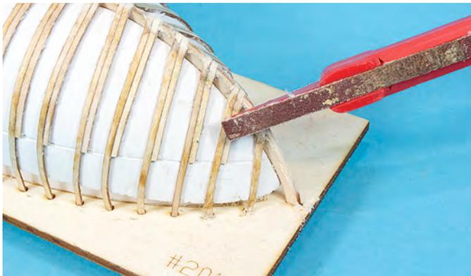
Das erste Kielteil mit den Spanten wird verschleiffen und das zweite Kielteil aufgeklebt.
