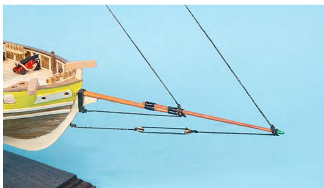
Das Stag S2 läuft vom Ende der Überlappung des Bugspriets zur Mitte der Überlappung des Fockmasts. Das Stag S2 wird am Ende des Bugspriets und ca. 55 mm unterhalb der Mastspitze des Fockmasts befestigt. Das Stag S4 läuft von der Mitte der Überlappung des Fockmasts zum Ende der Überlappung des Grossmasts. Das Stag S3 wird ca. 29 mm unterhalb der Mastspitze des Fockmasts befestigt und läuft ca. 8 mm unterhalb der Mastspitze des Grossmasts.
