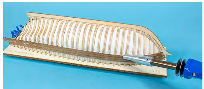
Die ersten drei Planken werden unverjüngt angebracht. Einen Tropfen Kleber auf den Spant geben, Planke ansetzen und mit der Form- und Biegespitze andrücken, aber nur im Bereich der Spanten, über die Zwischenräume nur sanft streichen, damit die Planken nicht eingedrückt werden.
