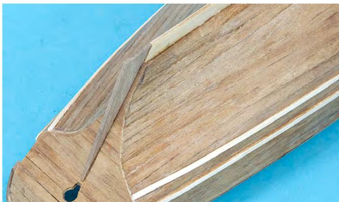
Schneiden Sie die überstehenden Spanten bündig mit der Bordwand ab und verschleifen die Spanten mit der Bordwand um eine saubere Auflagefläche zu erhalten. Nun können Sie die Rumpfschale auch von innen versäubern. Klebstoffreste werden wieder mit der Form- und Biegespitze oder einer Mini-Bohrmaschine entfernt.
