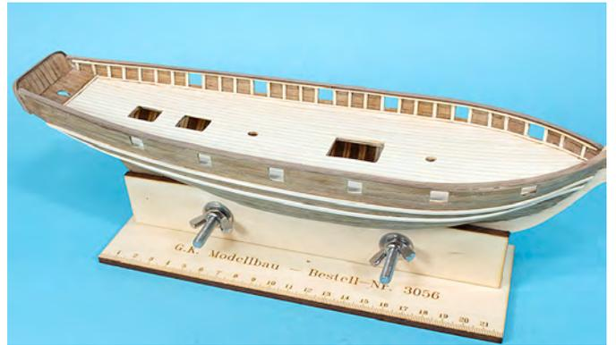
Als nächstes werden die Stückpfortentempel (Karte 3, Position 10) auf die Spanten neben die Stückpforten gesetzt. Die Stiftösen (Position 26) werden gekürzt und in die Stückpfortentempel eingeklebt. Mit der Unterseite stehen die Stückpfortentempel auf dem Wasserpaß und werden auf die Spanten, bis Unterkante Handlauf, geklebt.
