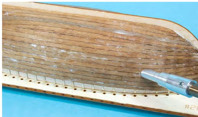
Nun wird der Rumpf abgedichtet, hierzu wird die Rumpfschale wieder auf der Malle befestigt und mit wasserlöslichem Weissleim eingestrichen, mit einem feuchten Tuch grob abgewischt und mit grobem Schleifpapier, Körnung 100-120, überschliffen.
