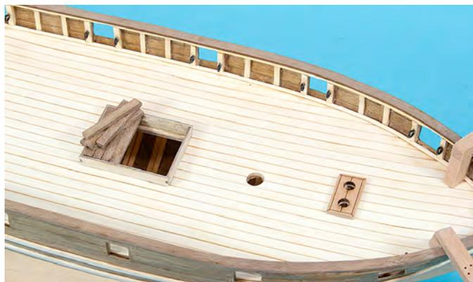
Der Rahmen des Oberlichts wird verklebt und die Oberlichtabdeckung aufgesetzt. Beim Niedergang werden die Seitenteile mit dem Vorderteil verklebt. Der kleine Balken dient als Abstandhalter, damit die Seitenteile sich nicht nach innen verbiegen. Die Niedergangs-Abdeckung wird kurz gewässert, mit der Form- und Biegespitze vorgebogen und dann aufgeklebt. Beim Oberlicht und Niedergang haben wir die Abdeckungen mit einer Maron-Lasur behandelt.
