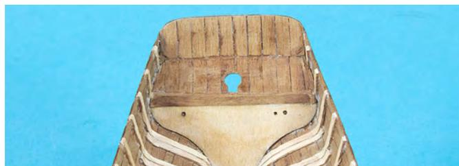
Dann wird auf die Decksstützleiste ein Decksbalken 2 x 2 mm aus (Karte 3, Position 11) geklebt. Beginnen Sie im mittleren Bereich Spant 6 - 19. Falls Ihre Rumpfschale etwas zu weit ist, können Sie sie mit ein paar Gummiebänder auf die richtige Breite bringen. Die Länge der Decksbalken entnehmen Sie bitte der Tabelle. Auf die Spanten 1, 12 & 13, 22 und 25 werden keine Decksbalken geklebt.
