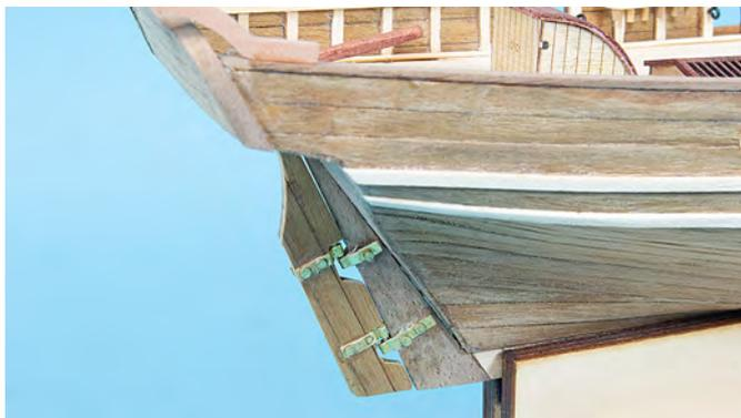
Versäubern Sie nun die Ruderpinne (Beutel 24) und brechen im vorderen Bereich die Kanten, so das ein nahezu rundes Profil entsteht. Der hintere Bereich muss etwas abgeflacht werden, so das die Ruderpinne in das Ruder gesteckt werden kann. Die Ruderpinne wird nur in das Ruder gesteckt, falls Sie sie verkleben, können Sie das Ruder nicht mehr abnehmen.
