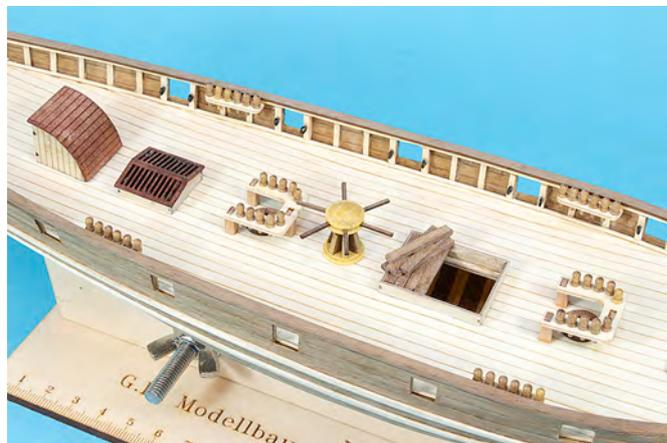
Die Heckdavids (Karte 3, Position 8) werden aus der Platine getrennt, versäubert und im Heck auf den Handlauf geklebt. Am Ende der Davids wird dann noch eine 0,9 mm Bohrung angebracht.
