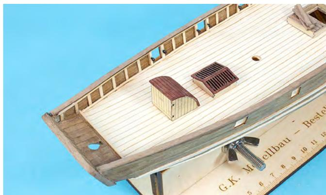
Jetzt werden die Mastfüsse (Beutel 26) auf das Deck geklebt. Die U-Förmigen Nagelbänke (Beutel 26) werden aus der Platine ausgetrennt, versäubert und mit Belegnägeln (Beutel 26) versehen. Die Nagelbankstützen versäubern und in die Nagelbänke einkleben. Die Nagelbänke können dann über die Mastfüsse auf das Deck geklebt werden.
