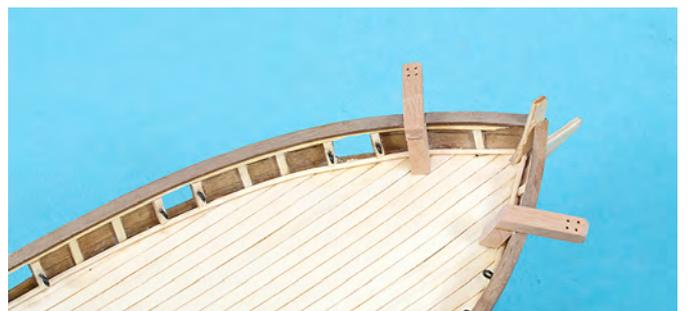
Die Kabelgattabdeckung (Position 22) wird zwischen Spant 5 und 6 mittig auf Deck geklebt. Die Bohrungen werden mit einem 3 mm Bohrer auf das Deck übertragen.
