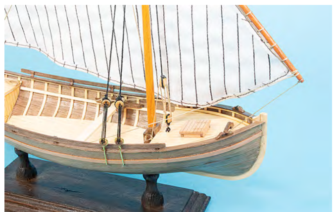
Der Doppelblock B3 wird an die Stiftöse A1 angeknötet. Der Takelhaken (Position 16) wird an ein dickeres schwarzes Tau geknötet, das Tau läuft durch den Mastkopf.
