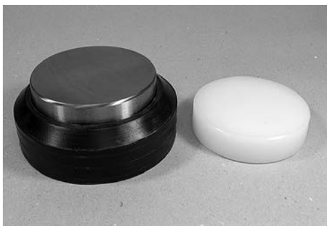
3155 Kombi-Amboss: Mit einem Stahleinsatz für Metallarbeiten und einem Kunststoffeinsatz als Unterlage für empfindliche Teile. Mit geräuschkämpfender Unterlage, für die Aufnahme des Stahl- oder Kunststoffeinsatzes. Härte des Stahleinsatzes: 45 - 50 HRC Durchmesser der Einsätze: 75 mm
