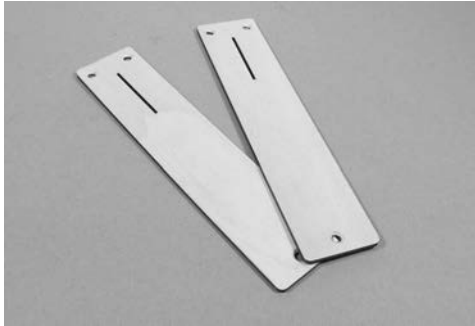
Bestell-Nr. 3171 Nullspaltabdeckung für Proxxon für die Proxxon FET 27070, 2 Stück. Diese wird gegen die original Proxxon Abdeckung ausgetauscht und bei abgesenktem Sägeblatt eingesetzt. Bei laufender Maschine wird das Sägeblatt hochgedreht und so der minimale Spalt für das Sägeblatt gesägt.
