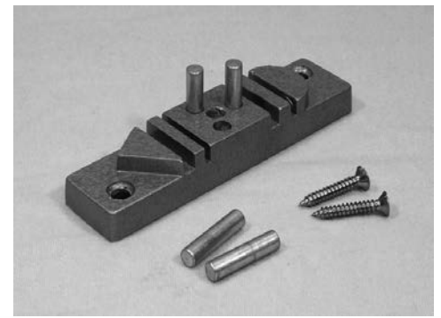
Bestell-Nr. 3113 Mini-Biegevorrichtung: Biegevorrichtung (112 x 26 x 16 mm) aus Alu-Druckguss mit verschiedenen Aussparungen und 4 steckbare Zylindern, kann in einem Schraubstock gespannt werden oder direkt auf dem Werkstisch geschraubt werden.
