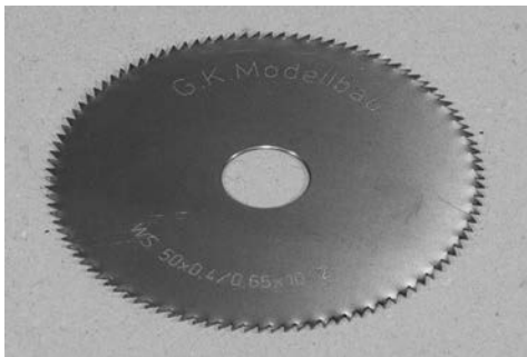
Bestell-Nr. 3013 Sägeblatt, Durchmesser 50 mm x 0,4 mm, 106 Zähne rechts/links geschränkt, Schnittbreite 0,7 mm, Aufnahme 10 mm, geeignet für Proxan-Sägen und andere.
