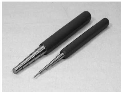
Bestell-Nr. 3112 Ösenwickeldome: Für das Anfertigen von runden Ösen. Rostfreie Stahl 10-stufig Ø 1,6; 2,6; 3,6; 4,6; 5,6; 6; 7; 8; 9 und 10 mm, Länge: 150 mm, Weiche Kunststoffgrille
