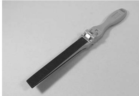
Bestell-Nr. 3172 Praktische Schmirgelleile die ein schnelles und einfaches Austauschen des Schmirgelstreifens erlaubt. Lieferung inkl. Schmirgelstreifen Körnung 180. Länge 270 mm, Breite 16 mm
