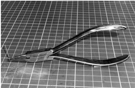
Bestell-Nr. 3031 Profi-Ösenzange aus Poliertem Edelstahl, mit 3 Abstufungen zur Fertigung von Ösen und Stiftdösen. Durchmesser sind 2 mm, 3 mm und 4,5 mm
