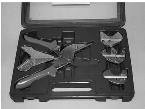
Bestell-Nr. 3076 Profi-leistenschnider für Holzleisten bis 12 mm, mit fünf Wechselback u.a. für Rundstäbe, auf der Winkelbacke sind die am meisten gebrauchten Winkel.
