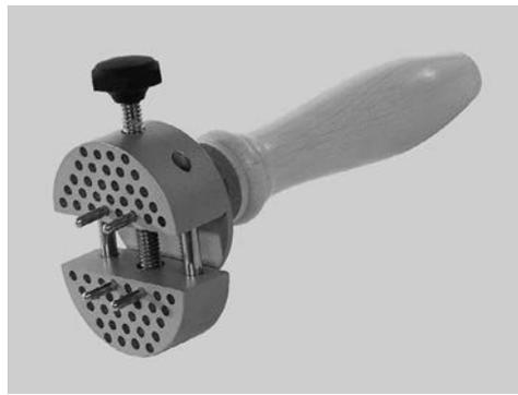
Bestell-Nr. 3060 Universal-Werkstückhalter, ideal für kleine und unregelmässig geformte Werkstücke. Inklusive 8 Stahlstiften zum Befestigen von irregulären Formen. Spannweite 50 mm, Backenbreite 21 mm, Grifflänge 115 mm
