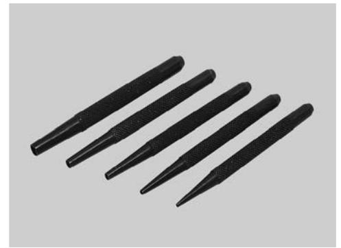
Bestell-Nr. 3062 Nageltreiber/Durchschläge, 5-tlg. Satz, ver- güteteter und geschwärtzter Stahl mit gerändeltem Grill und runder Vertiefung an der Spitze für den Nagelkopf. Größen 1,5; 2,5; 3; 4; und 5 mm
