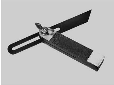
Bestell-Nr. 3067 Mini-Tischlerschmiege, aus poliertem Hartholz mit soliden Messing-Abschlusskappen und Messing-Flügelschraube. Mit einer 100 mm Zunge aus gebläutem Stahl zum übertragen von Winkeln.
