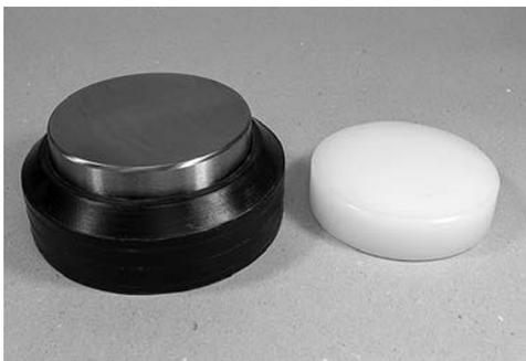
3155 Kombi-Amboss: Mit einem Stahleinsatz für Metallarbeiten und einem Kunststoffeinsatz als Unterlage für empfindliche Teile. Mit geräuschkämpfender Unterlage, für die Aufnahme des Stahl- oder Kunststoffeinsatzes. Härte des Stahleinsatzes: 45 - 50 HRC Durchmesser der Einsätze: 75 mm
