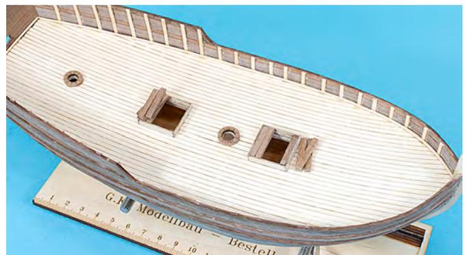
Am Achterdeck wird die Deckstützleiste (Karte 3, Position 8) 4 mm unterhalb der Bergeleiste angebracht.
