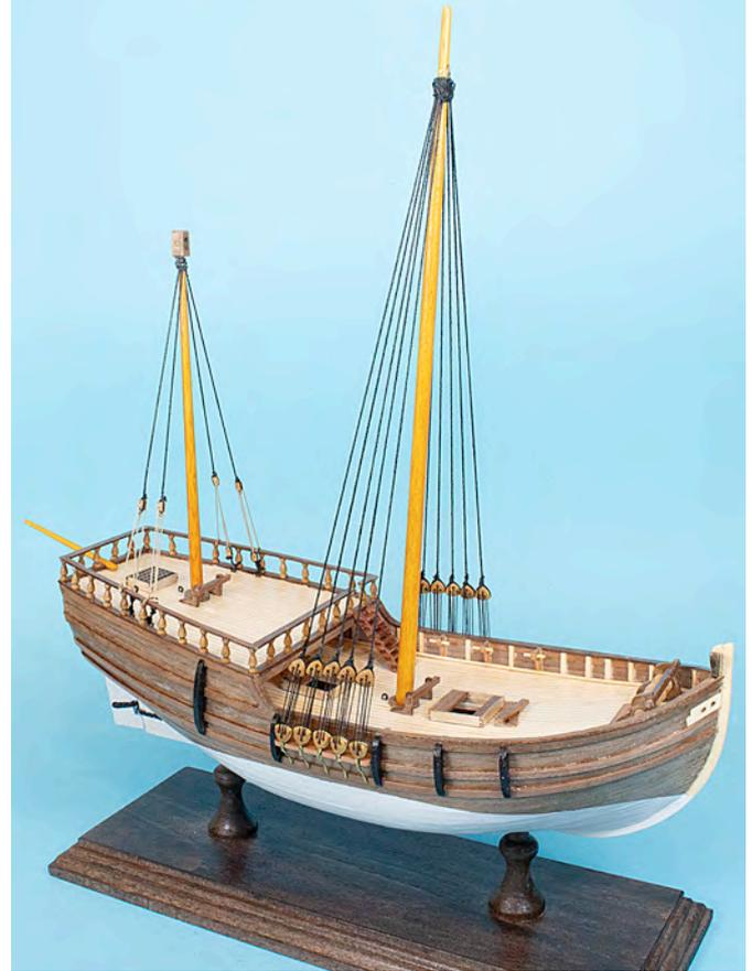
Die Ruten werden durch eine Schlaufe am Mast gehalten, auf das Tau werden dazu Perlen aufgefädelt (Karte 1, Position 26). Am Großmast ca. 15 Perlen und am Besanmast ca. 10 Perlen.
