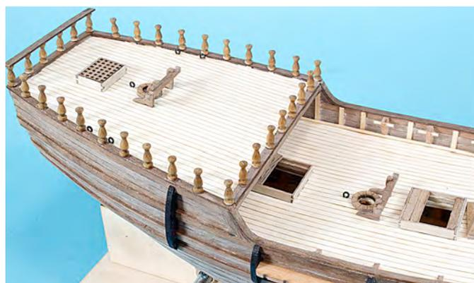
Auf die Geländerstützen wird die Reling (Karte 2, Position 7) geklebt, auch diese müssen wie der Handlauf vorgebogen werden. Für den Ausgang wird in der Reling eine Lücke gelassen.
