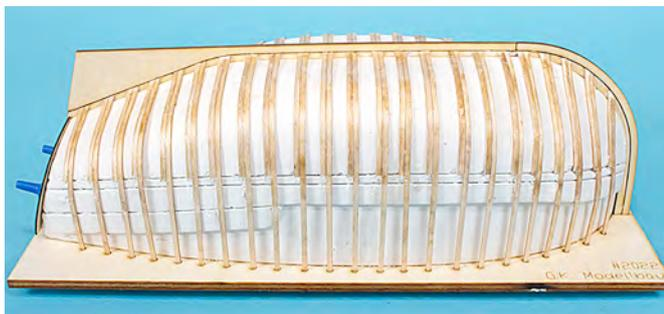
Das erste Kielteil mit den Spanten wird verschleiffen und das zweite Kielteil und der Aussensteven aufgeklebt.
