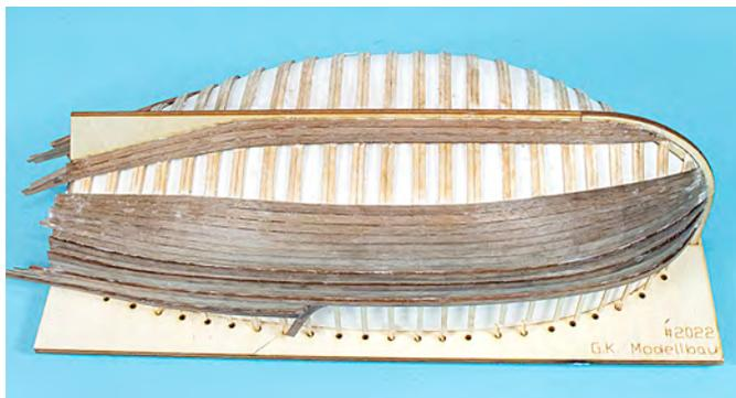
Einen Tropfen Kleber auf den Spant geben, Planke ansetzen und mit der Form- und Biegespitze andrücken, aber nur im Bereich der Spanten, über die Zwischenräume nur sanft streichen, damit die Planken nicht eingedrückt werden. Nach dem man acht weitere Planken gesetzt hat, sollte man vom Kiel aus beplanken, so erreichen Sie einen sauberen Abschluss am Kiel.
