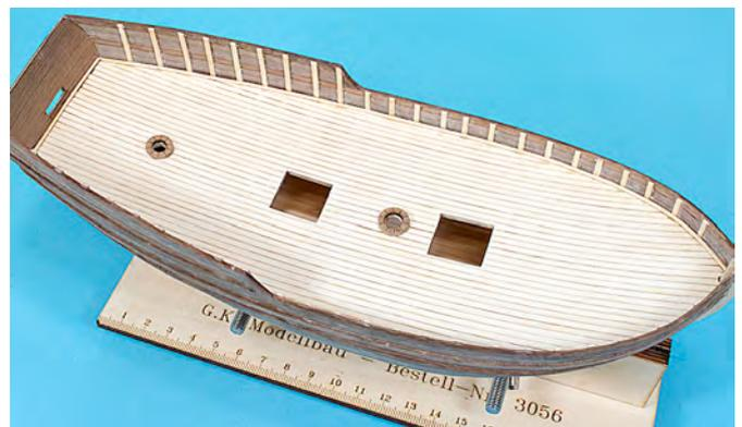
Die Ladeluken (Karte 3, Position 20) haben einen äußeren und inneren Rahmen, bauen Sie zuerst den äußeren Rahmen zusammen. Passen Sie dann den inneren Rahmen an und kleben ihn in den äußeren Rahmen. Bei den Ladeluken haben wir nur einen Teil der Ladelukenabdeckung (Beutel 20) eingesetzt. So kann man auch noch beim fertigen Modell in den Rumpf sehen.
