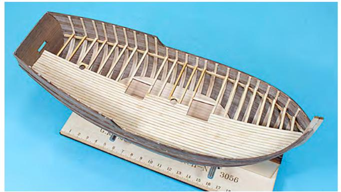
Die Leisten aus Karte 3, Position 11 werden als Wasserpass an die Spanten und auf das Deck geklebt.
