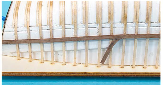
Eine weitere Bergeleiste wird gegen die hochgebogene Bergeleiste und auf die Spanten im achterlichen Bereich geklebt.
