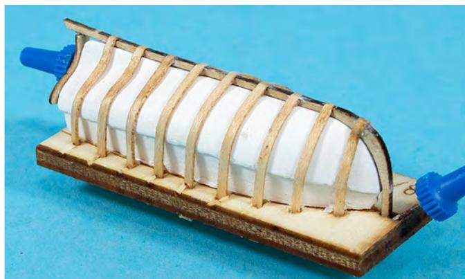
Sind alle Spanten gesetzt und angepasst, muss im Bugbereich eine Sponung eingearbeitet werden. Schleifen Sie dazu die Kanten des Kielteils im Bugbereich mit einer Schleiffeile oder schneiden Sie die Kanten mit einem Messer weg.
