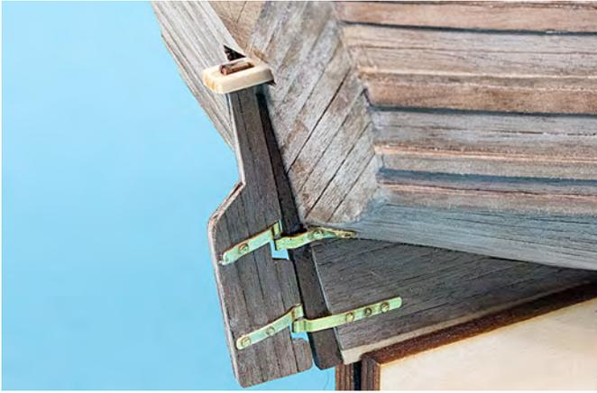
Halten Sie das Ruder an den Achterstegen und markieren die Position der Ruderscharniere. Kleben Sie die Scharniere auf das Kielfüllstück und sichern es wieder mit Messingnägeln. Versäubern Sie nun die Ruderpinne (Karte 1, Position 23) und brechen im vorderen Bereich die Kanten, so dass ein nahezu ovales Profil entsteht. Die Ruderpinne wird nur auf das Ruder gesteckt.
