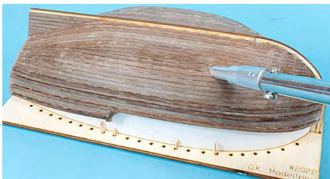
Nun wird der Rumpf abgedichtet, hierzu wird die Rumpfschale wieder auf der Malle befestigt und mit wasserlöslichem Weissleim eingestrichen, mit einem feuchten Tuch grob abgewischt und mit grobem Schleifpapier, Körnung 100-120, überschleift.
