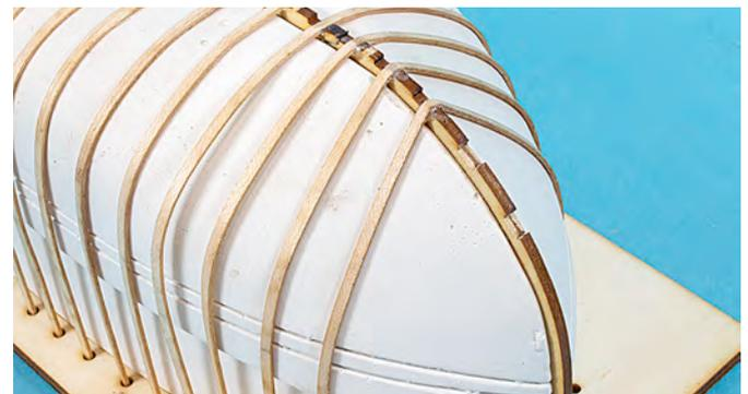
Nach dem alle Auflanger gesetzt sind, werden die Halbspanten gesetzt, diese sitzen links neben den Auflangern (vom Bug aus gesehen). Die Halbspanten reichen nur bis zur Markierung in der
