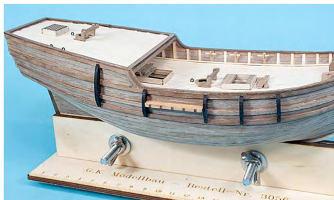
Für die Reling des Achterdecks müssen Geländerstützen angebracht werden, an jeder Ecke wird eine Geländerstütze platziert. Zwischen den Eckstützen werden die Stützen in einem Abstand von ca. 10 mm platziert. Um die Stützen senkrecht aufzukleben muss die Unterseite leicht schräg angeschliffen werden.
