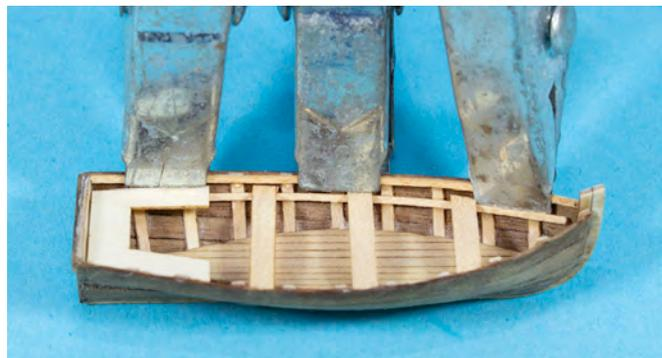
Bevor man die Handläufe aus Position 4 auf die Handlaufstützleiste und Bordwand klebt, muss man sie vorbiegen.
