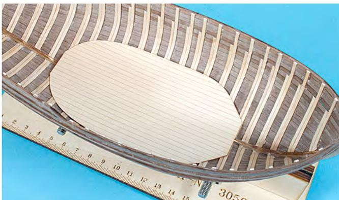
Auf das Bodenbrett wird die Runde Mastfischung (Karte 1, Position 1) geklebt, positioniert wird die Mastfischung zwischen den Spanten 11 und 12.
