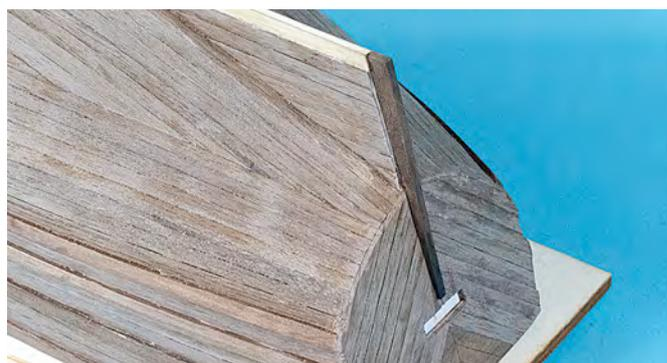
Schneiden Sie die überstehenden Spanten bündig mit der Bordwand ab und verschleifen die Spanten mit der Bordwand um eine saubere Auflagefläche zu erhalten. Nun können Sie die Rumpfschale auch von innen versäubern. Klebstoffreste werden wieder mit der Form- und Biegespitze oder einer Mini-Bohrmaschine entfernt. Der Heckspiegel wird dann noch von innen Wagerecht beplankt.
