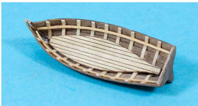
Die achterne Sitzbank aus der ersten Position wird angepasst und auf die Ruderbankstützleisten ins Heck geklebt. Material für die Ruderbänke befindet sich in der letzten Position. Die Position der Ruderbänke entnehmen Sie dem Bauplan.
